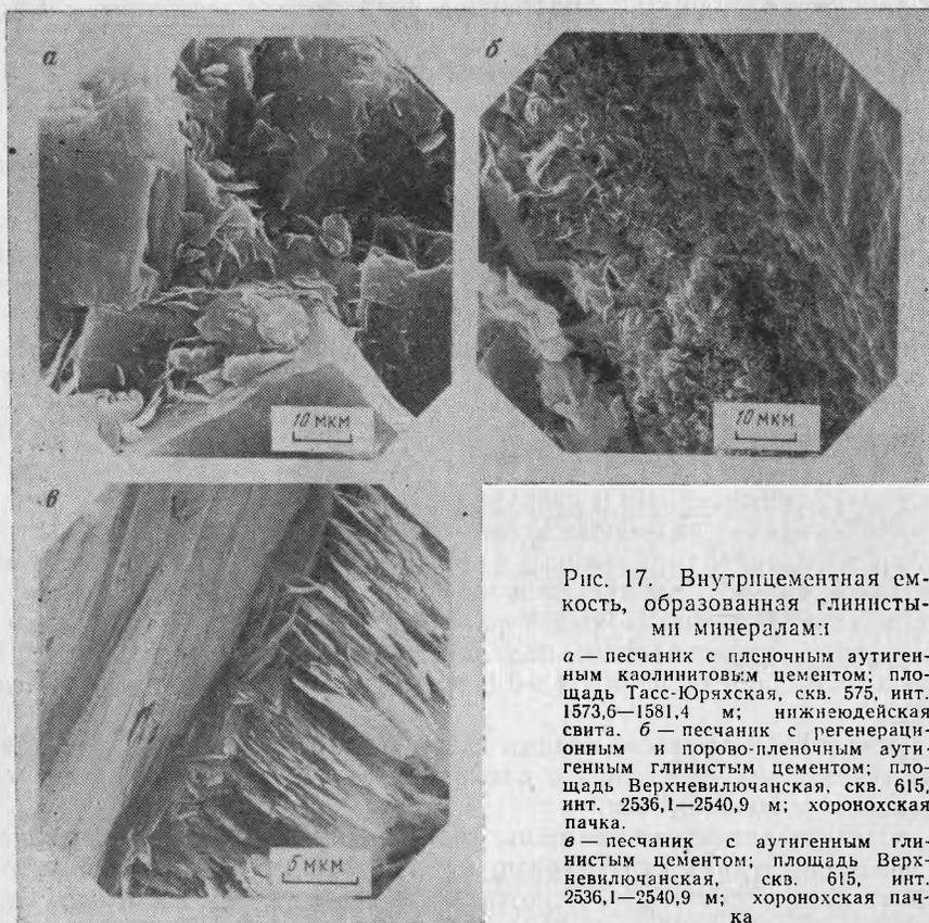
Рис. 17. Внутрицементная емкость, образованная глинистыми минералами
