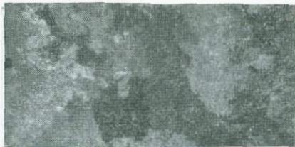
Рис. 9. Пойкилобластовая структура. В крупном идиоморфном кристалле гипса прослеживаются мелкие зерна ангидрита.
