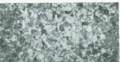
Рис. 3, 4. Ангидрит тонкозернистой структуры.
