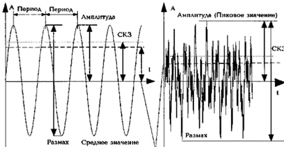
Рисунок 1.10 – Кривые синусоидальной и полигармонической вибрации
