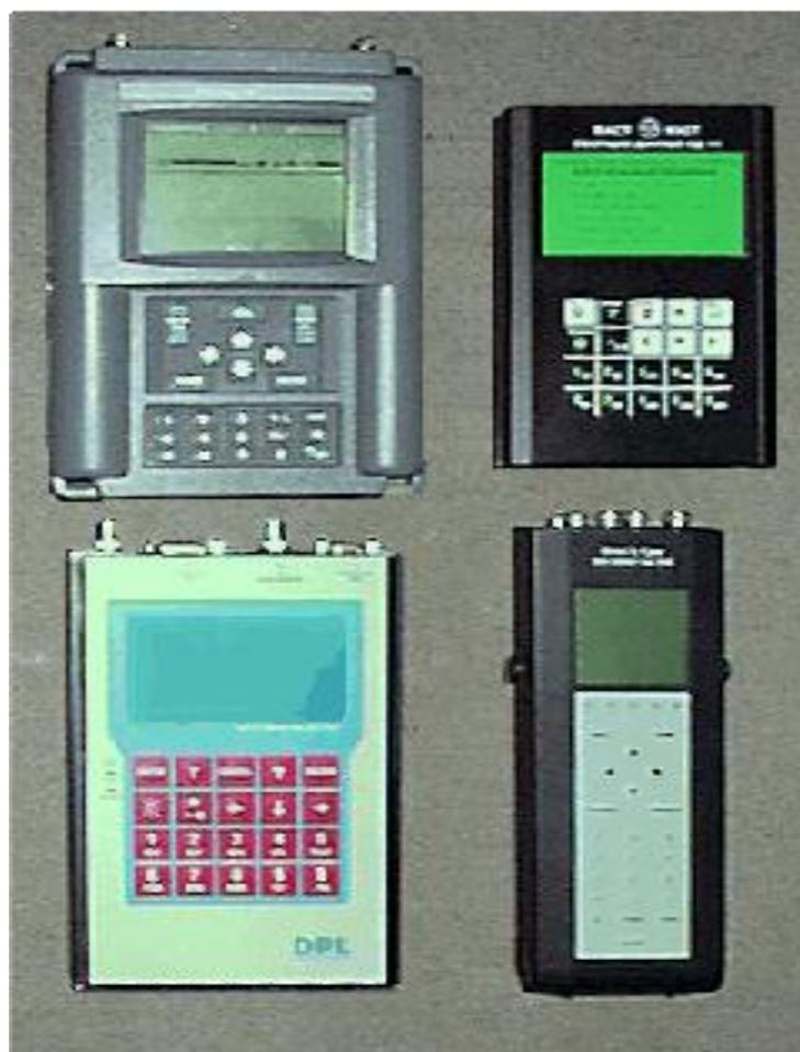
Рисунок 9.1 - DI-1100 Сборщик данных (Data Collector) - Diagnostic Instruments, Inc., Великобритания; СД-11 Сборщик данных (анализатор сигнала) - АО ВАСТ, Россия; DC-11 Сборщик данных (анализатор сигнала) - DPL Group, Канада; Сборщик данных 2526 - Bruel and Kjaer, Дания.
