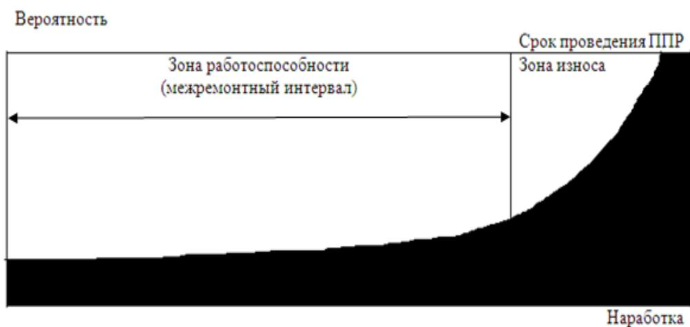
Рисунок 1.2 – Классическая схема, лежащая в основе планово-профилактического обслуживания
