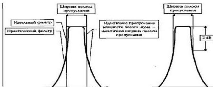
Рисунок 1.14 – Эффективная ширина полосы пропускания на основе мощности белого шума (слева) и ширина полосы пропускания на уровне 3дБ (справа)
