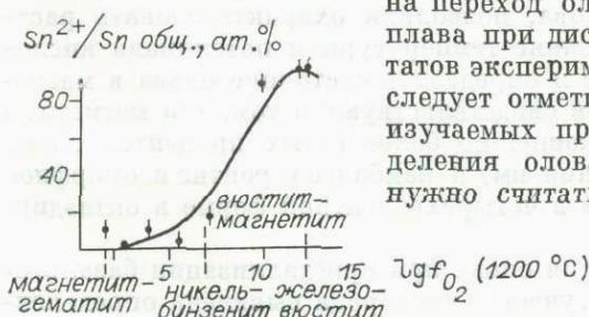
Рис. 1. Валентное состояние олова в гавайите при различных потенциалах кислорода.
