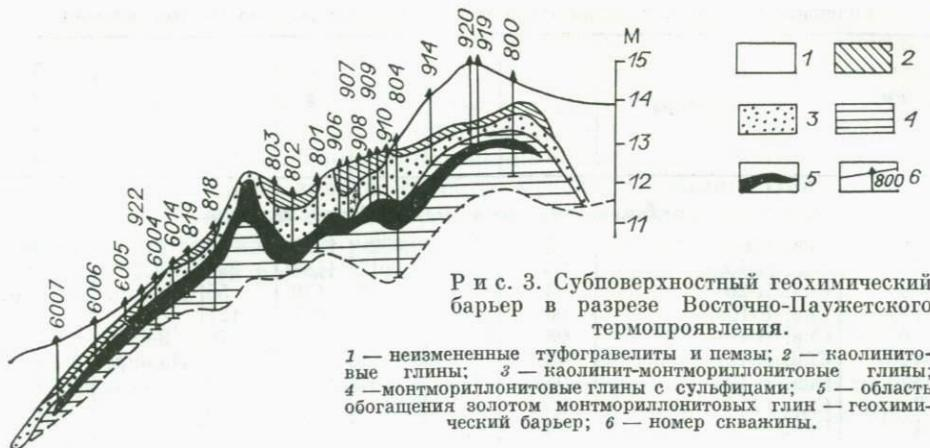
Рис. 3. Субповерхностный геохимический барьер в разрезе Восточно-Паужетского термопроявления.
