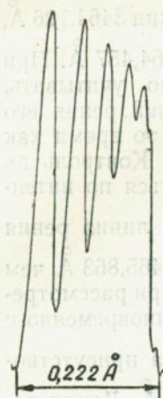
Рис. 100. Сверхтонкая структура линии Re 3460,465 Å. (Дисперсия 1 Å/мм).
