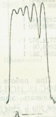
Рис. 83. Регистраграмма линии висмута 3405,660 Å (дисперсия 1 Å/мм.)
