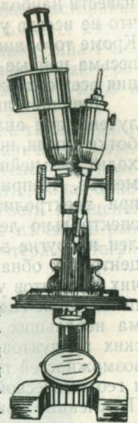
Рис. 77. Бинокулярная лупа, снабженная микросверлом [44].
