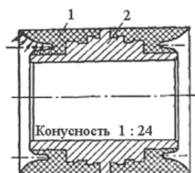
Рис. 3. Поршень с резиновыми самоуплотняющимися манжетами:
