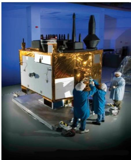
*Рис. 11. Корпус блочного IIR GPS-спутника*
