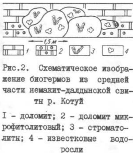
Рис.2. Схематическое изображение биогермов из средней части немакит-далдынской свиты р. Котуй
