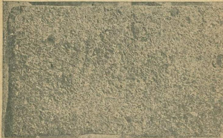
Фот. 4. Глыба № 206. Поверхность параллельна слоистости (до испытания)
