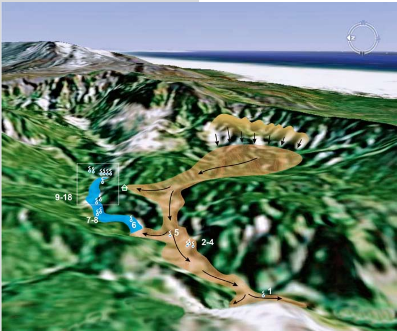
Рис. 10. Схема оползня, произошедшего 3 июня 2007 в Долине гейзеров на Камчатке (В. Л. Леонов, А. В. Леонов). Вид на восток. Стенка отрыва – желтая, тело оползня – коричневое, запрудное озеро – синее. Стрелками показано направление движения оползня и грязекаменного потока. В рамке основная группа гейзеров, не пострадавшая от оползня. Гейзеры: 1 – Первенец; 2–4 – Тройной, Сахарный, Сосед; 5 (затоплены озером) – У водопада, 6 – Скалистый, 7, 8 – Конус, Большая Печка; 9–18 – Малый, Большой, Щель, Грот, Новый Фонтан, Фонтан, Двойной, Непостоянный, Великан, Жемчужный
