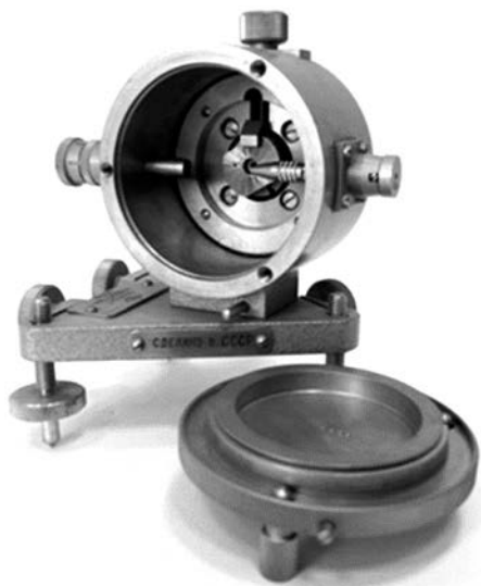
Рис. 5.18. Рентгеновская камера типа РКД-57 для получения дебаеграмм
