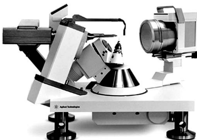
Рис. 5.25. Рентгеновский четырехкружный гониометр без вертикального лимба (фирма Oxford Diffraction Gemini, Великобритания)
