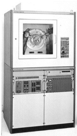
Рис. 5.22. Однокружной дифрактометр D-500 фирмы Siemens (Германия) для исследования поликристаллов
