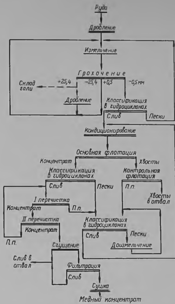
Рис. 5. Технологическая схема обогащения медной руды на фабрике "Эртсберг"
