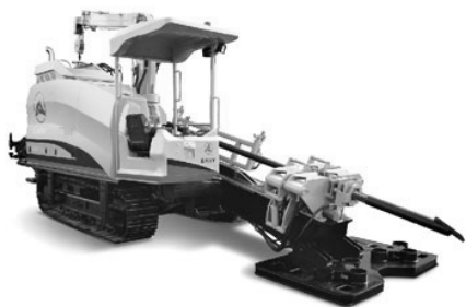
Рис. 6.8. Горизонтально-ориентированная буровая машина
