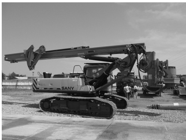
Рис. 6.9. Длинный роторный буровой станок (SR150C)
