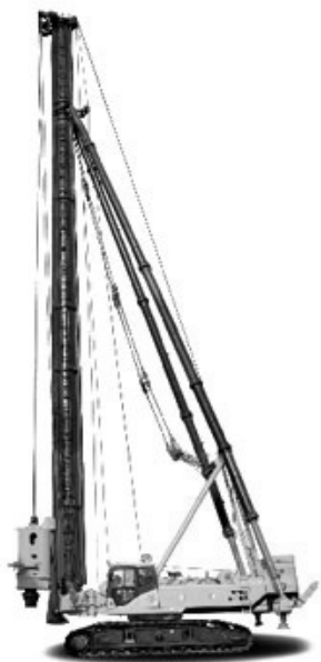
Рис. 6.6. Многофункциональная гидравлическая гусеничная свайная машина
