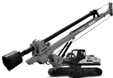
Рис. 6.10. Длинный роторный буровой станок (SR250R)
