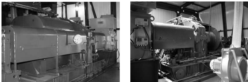
Рис. 5.8. Модуль буровой лебедки ЛБУ 1500-1
