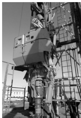
Рис. 2.17. Верхний привод гидравли- ческий
