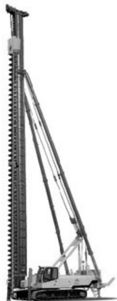
Рис. 6.7. Многофункциональная гидравлическая гусеничная свайная машина
