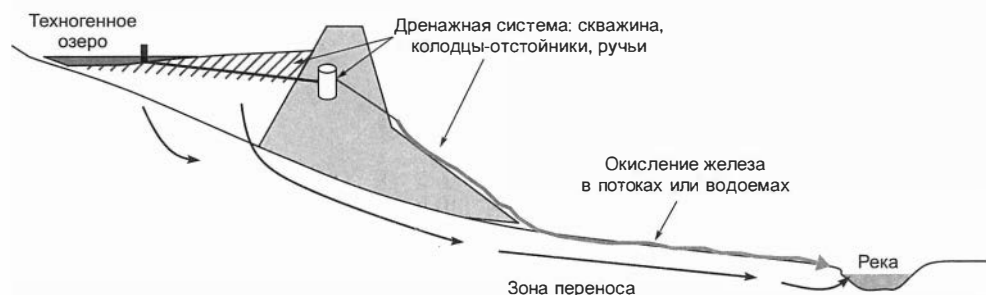
Рис. 4.1. Схема движения дренажа из техногенного озера в реку.
