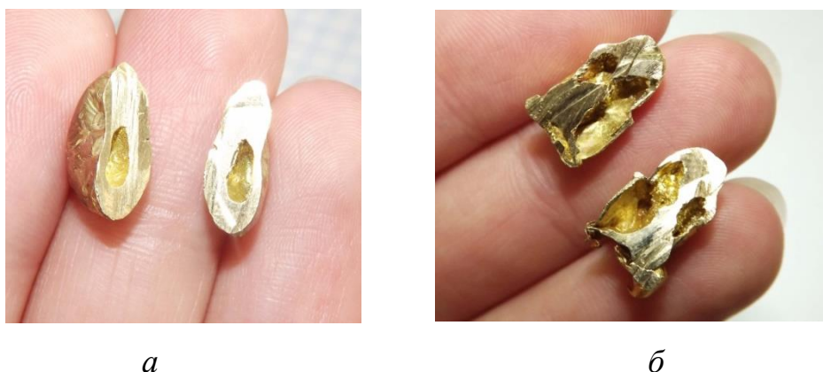
Рисунок 2.6 – Распил латунных отливок: а – характер пустот, обнаруженных в распиле отливки, полученной в горячей воде; б - характер пустот, обнаруженных в распиле отливки, полученной в холодной воде [54].
