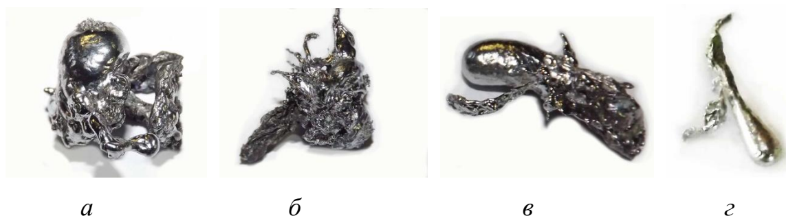
Рисунок 2.9 - Образцы имитаций самородков серебра, полученные при плавлении олова в течение 10-15 с: а – пример образцов, полученных при моментальной отливке; б – пример образцов, полученных при выдержке расплавленного металла в течение 5 с; в – пример образцов, полученных при 10-секундной выдержке; г – пример образцов, полученных при 15-секундной выдержке [57]
