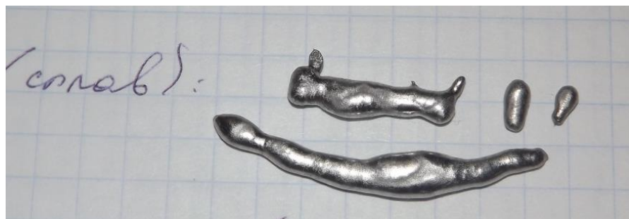
Рисунок 2.15 - Результат литья оловянно-свинцового сплава в емкость, заполненную 200 мл индустриального масла [57]
