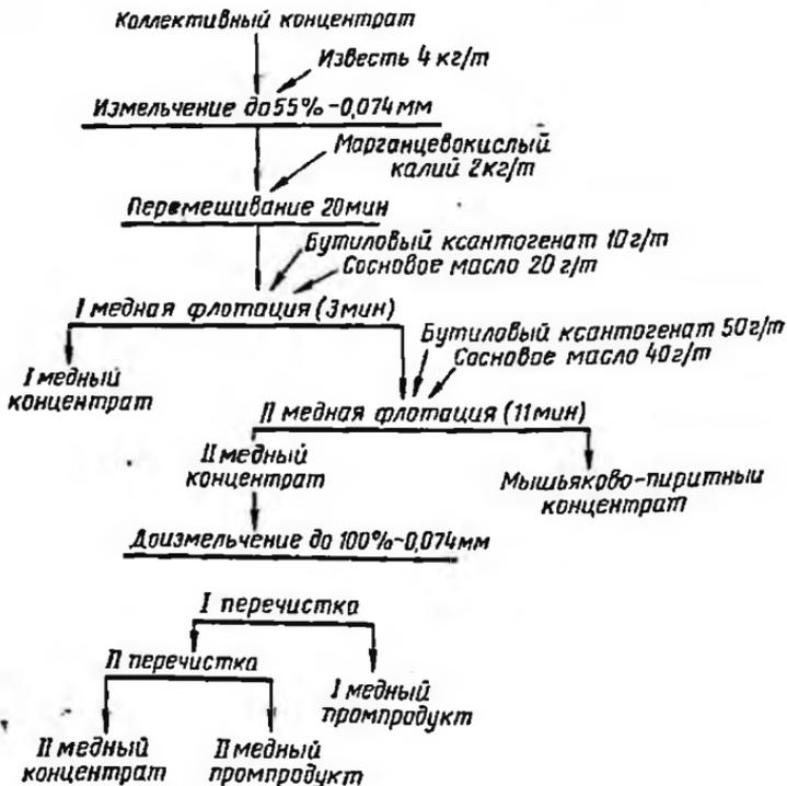
Рис. 2. Рекомендуемая схема флотационного разделения коллективного концентрата Дарасунской фабрики
