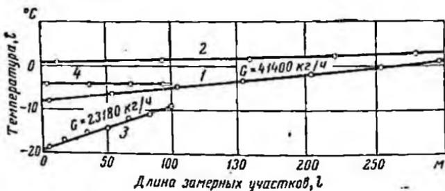
Рис. 2. Температура воздуха и горных пород на замерных участках. Температура воздуха (1) и горных пород (2) по штольне № 24. Температура воздуха (3) и горных пород (4) по штольне № 22
