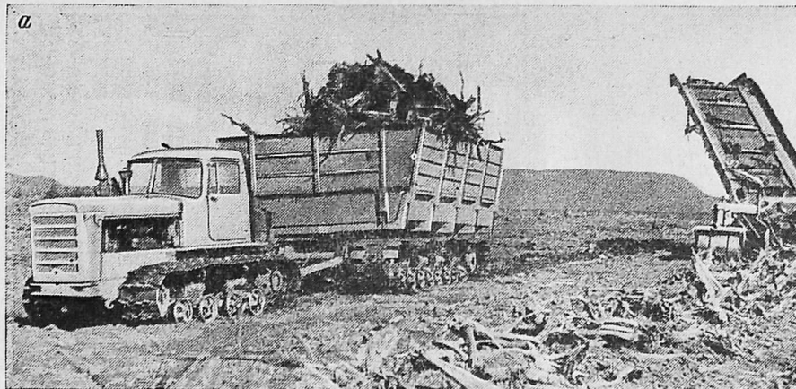
Рис. 47. Гусеничный прицеп-самосвал ГПС-2МП повышенной грузоподъемности с трактором ДТ-75Б:
