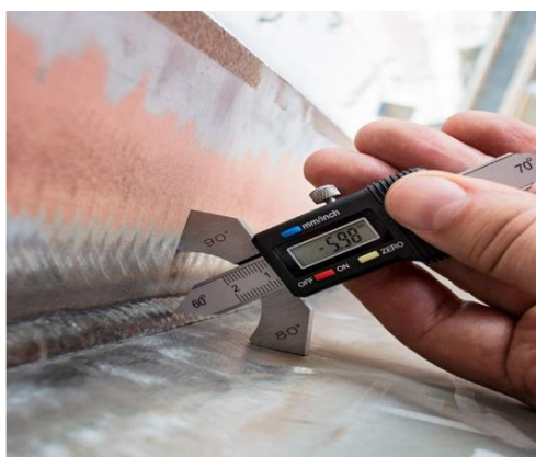
Рисунок 9.5 – Контроль качества сварного шва
