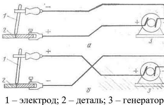
Рисунок 8.18 – Схема установки дуговой сварки постоянным током прямой (а) и обратной (б) полярности
