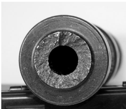
Рисунок 8.1 – Излом вала, возникший при расклинивающем действии присадки
