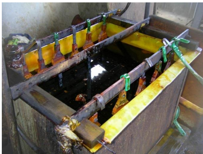
Рисунок 8.24 – Схема ванны для электролитического нанесения слоя металла
