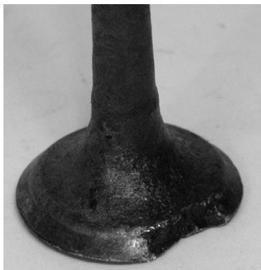
Рисунок 8.5 – Вид эрозионных повреждений клапана
