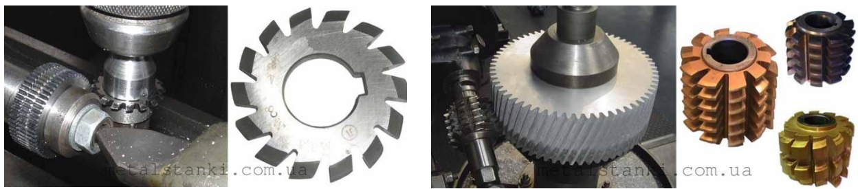
Рисунок 7.22 – Схема работы зуборезных инструментов
