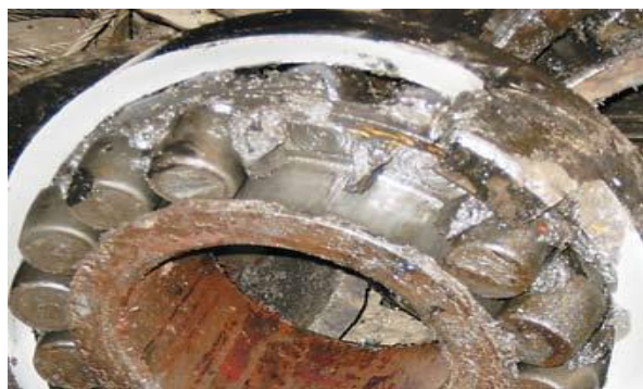
Рисунок 8.12 – Дефекты подшипников качения
