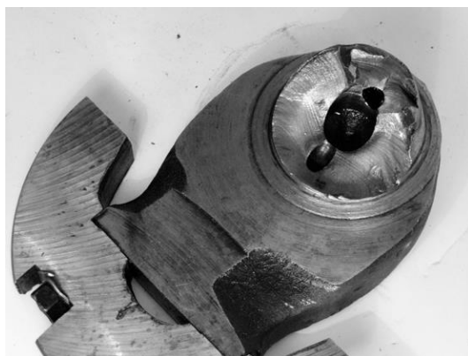
Рисунок 8.3 – Вид усталостного излома коленчатого вала
