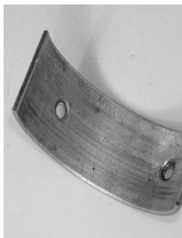
Рисунок 8.4 – Шейка и вкладыш коленчатого вала со следами задира
