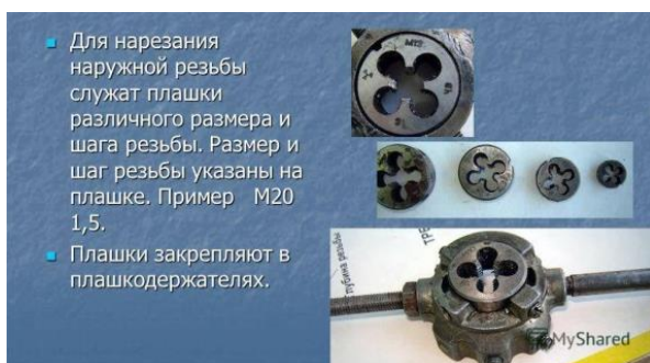
При нарезании наружных резьбы невысокой точности используют круглые плашки (рисунок 7.8). Элементы, обеспечивающие и характеризующие процесс резания и закрепление на станке или в воротке: режущие перья и стружечные отверстия, шаг резьбы, диаметр плашки, перемиčky, паз для разжимного винта, гнезда для крепежных винтов поверхностей.
