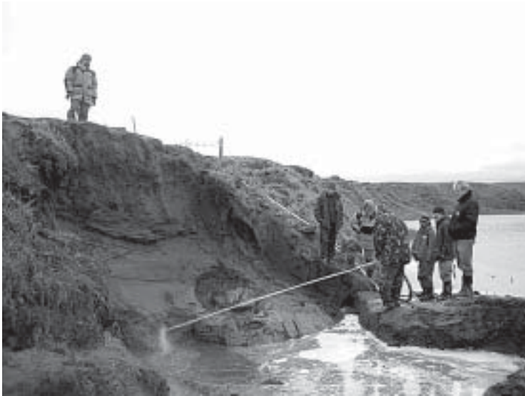
Рис. 17. Размыв мерзлоты мотопомпой
