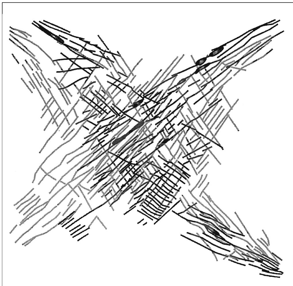
**Рис. 4.5.** Интегральная схема разломов, сформированных в слое, имитирующем платформенный чехол в течение 2 и 3-го этапов.
