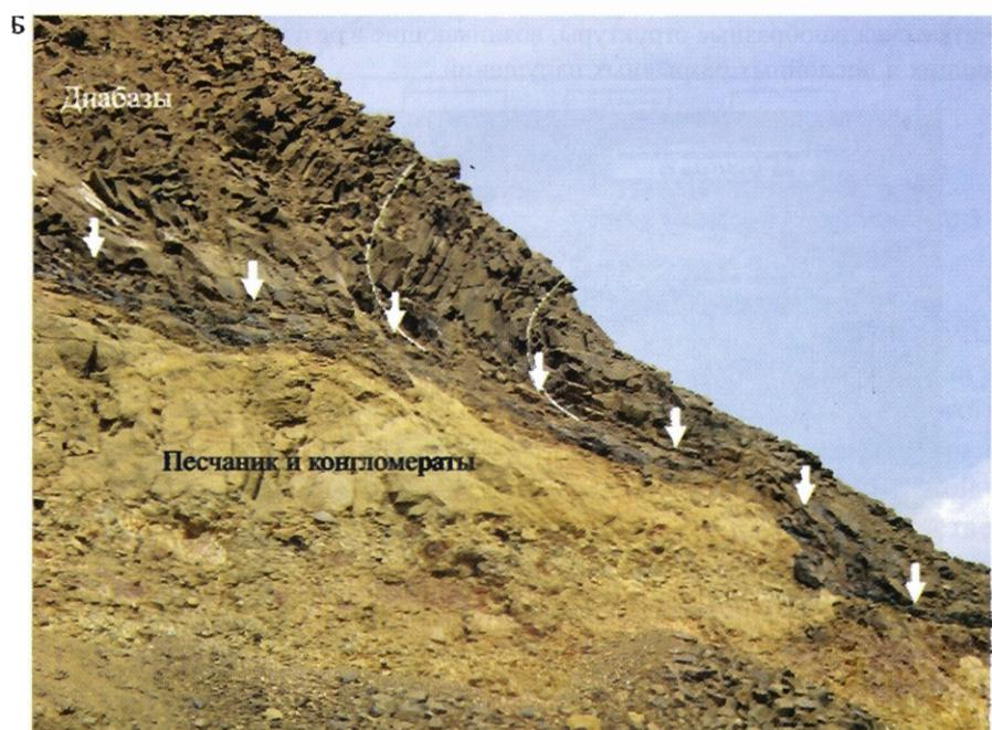
**Фиг. 23.** Карьер по добыче диабазов в окрестностях г. Мирный. Надвиговая зона мощностью 0.5–0.6 м (А), и ее фрагмент (Б).
