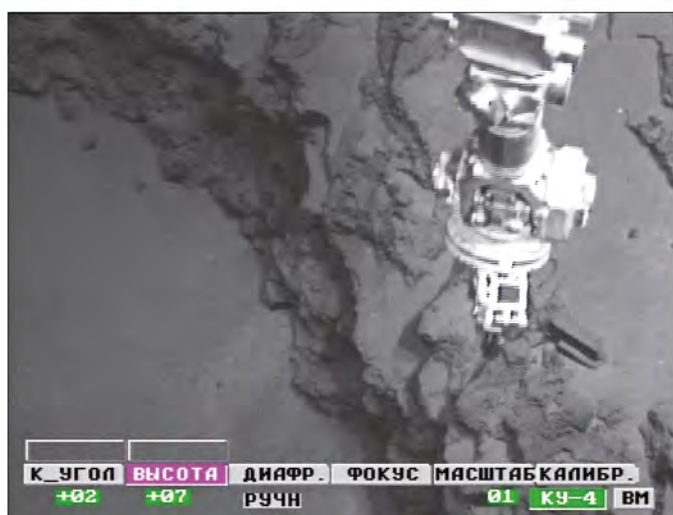
Отбор проб с поднятия Менделеева, осуществляемый исследовательскими подводными манипуляторами (фото Геослужбы ГИН РАН с экспедиции «Arctic-2014»)
