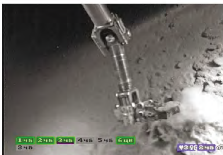
Отбор проб с поднятия Менделеева, осуществляемый исследовательскими подводными манипуляторами (фото Геослужбы ГИН РАН с экспедиции «Arctic-2014»)
