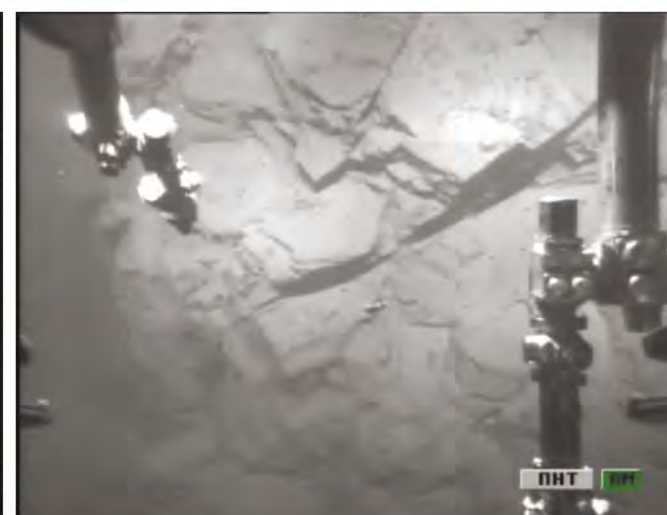
Отбор проб с поднятия Менделеева, осуществляемый исследовательскими подводными манипуляторами (фото Геослужбы ГИН РАН с экспедиции «Arctic-2014»)
