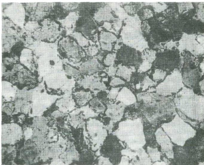
Рис. 8. Песчаник мелкозернистый кварцевый с регенерационным кварцевым цементом
