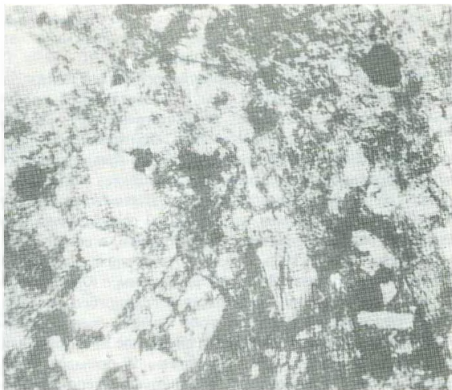
Рис. 19. Песчаник среднезернистый кварцевый с примесью пеплового материала
