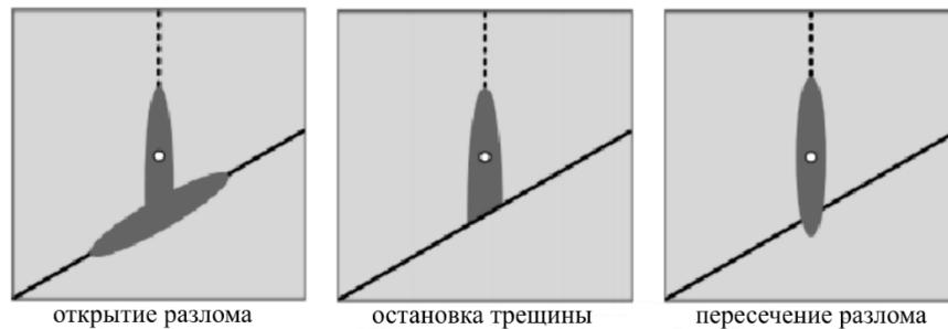
Рисунок 1.7 Варианты взаимодействия трещины ГПП с естественными разломами (Morgan W.E., 2014).
