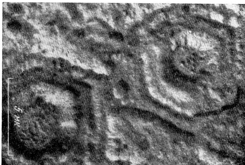
Рис. 4. Строение дислокационных центров, выявленное природным травлением
