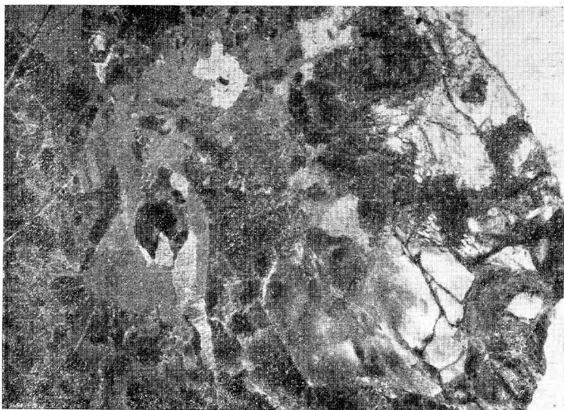
Рис. 5. Гранобластовая структура агрегата криолита второй генерации (1) из гнезда в кварц-полевошпатовой жиле. В криолите расположено идиоморфное зерно кварца (2) и корродированные зерна галенита (3)
