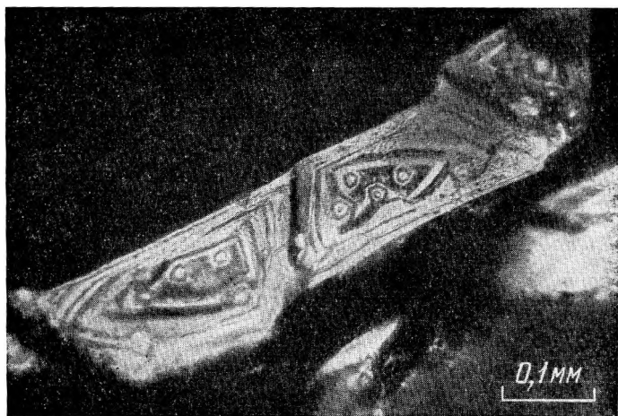
Рис. 3. Скульптура растворения на поверхности трапецидальных пирамид роста
