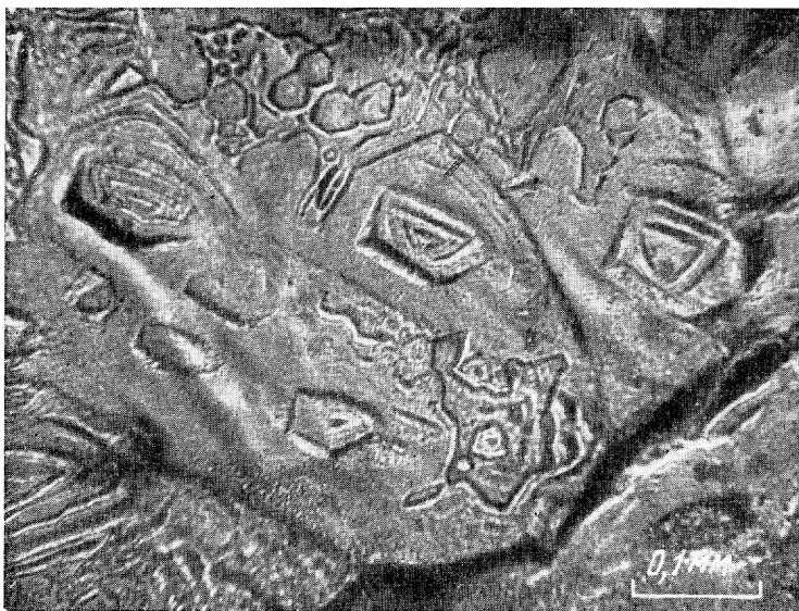
Рис. 5. Двойные спирали растворения на элементарных аксессуориях роста (в центре снимка)
