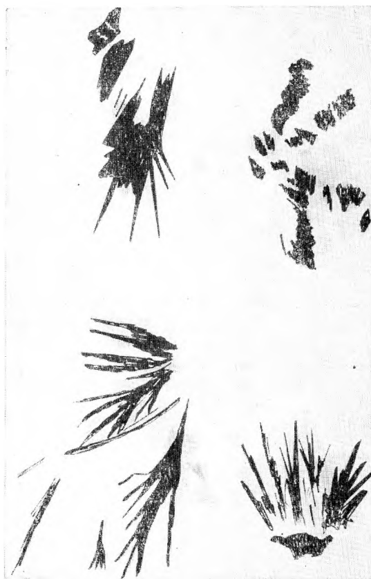
Рис. 1. Форма вростков кристаллов эвксенита в микроклине в произвольных поперечных срезах
