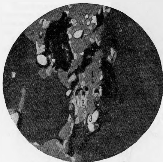
Рис. 3. Прожилок сфалерита (1) с зернами германита (2) в барите (черное). В сфалерите — единичные зерна пирита (3). Увел. 230
