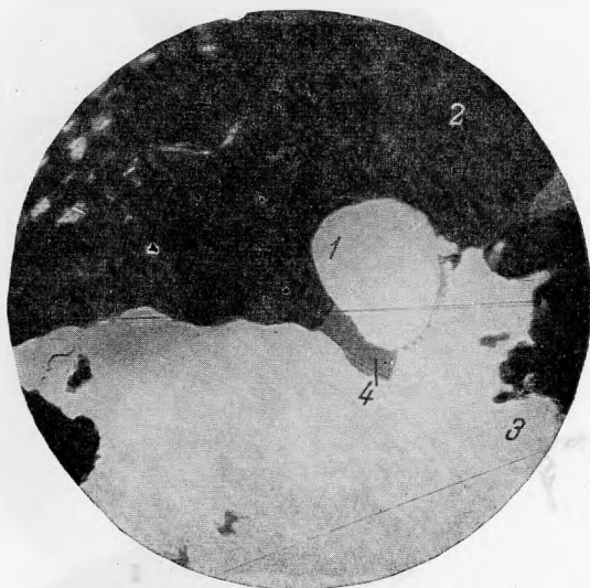
Рис. 2. Крупное зерно германита (1) в контакте барита (2) с блеклой рудой (3). Здесь же выделения борнита (4). Иммерсия, увел. 450
