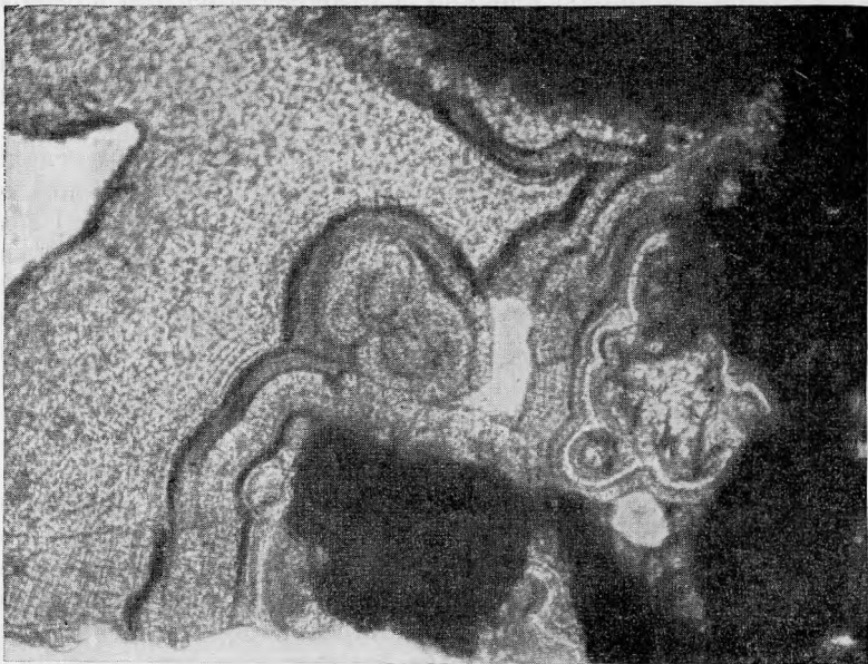
Рис. 6. Сферолиты бедантита имеют несколько ядер, заключенных в одну общую оболочку. Они нарастают на гидроокислы железа (черное), а на них кристаллизуется тонкоигольчатый бедантит в виде сплошной корочки. Шлиф 1291, ув. 150, без анализатора
