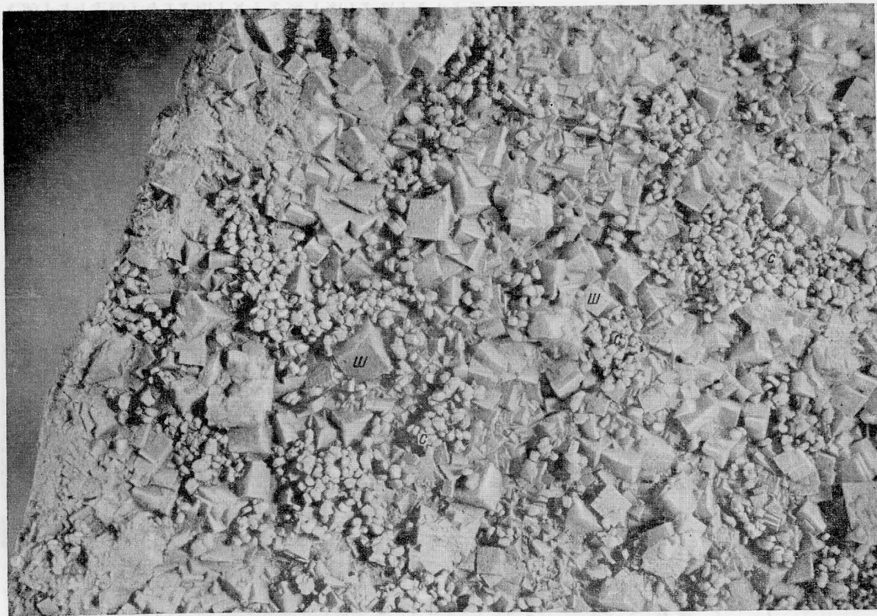
Рис. 1. Крystalлы стильбита (с) и шабазита (ш) в прожилке, секущем порфириты. Обр. 836, ув. 15. Штольня № 3
