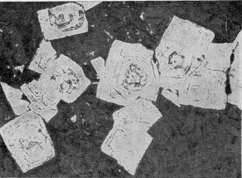
Рис. 5. Кристаллически-зональная внутренняя структура пирита. Месторождение Северо-Акатуевское. Полированный шлиф. Протравлено, \times 120
