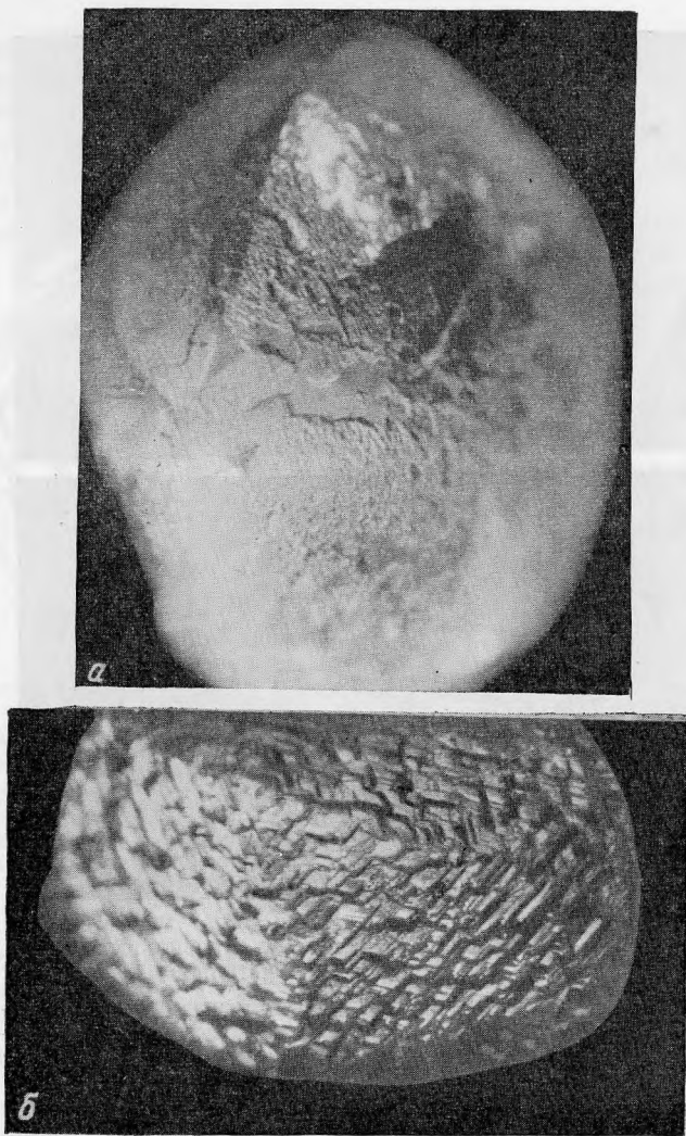
Рис. 7. Образование черепитчатой скульптуры на округлых кристаллах алмаза
