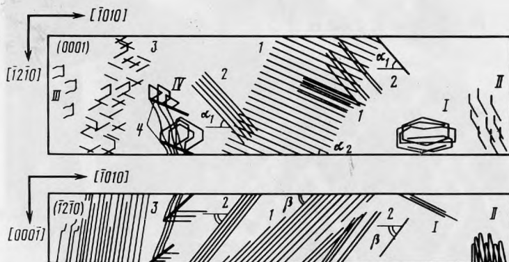
Рис. 2. Развертка граней (0001) и (\bar{1}2\bar{1}0) образца и относительное положение различных скоплений дислокаций, нанесенное в виде их проекций на грани
