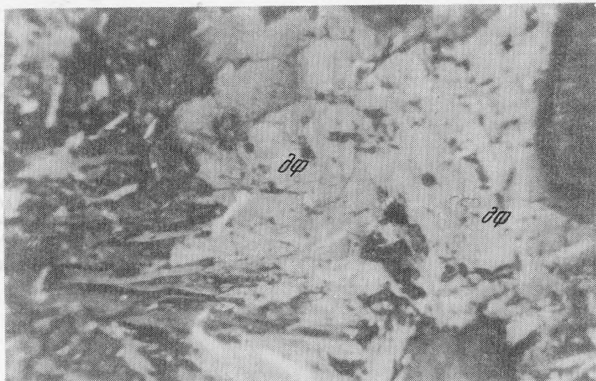
Рис. 2. Замещение диафорита (df) (сдвойникован) тонконгольчатый агрегатом джемсонита (дж). Аншлиф, с анализатором, увел. 200
