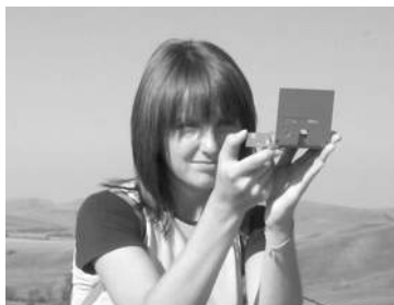
Рис. 5.3. Взятие азимута на ориентир компасом с зеркалом
