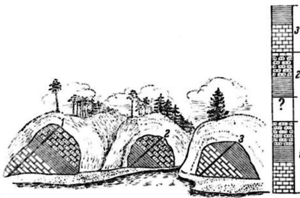
Рис. 6.1. Составление сводного разреза при крутом падении слоев. 1, 2, 3 – разрезы-колонки отдельных обнажений, используемые при составлении сводного разреза. Справа – итоговая колонка разреза (по В.А. Апродову)
