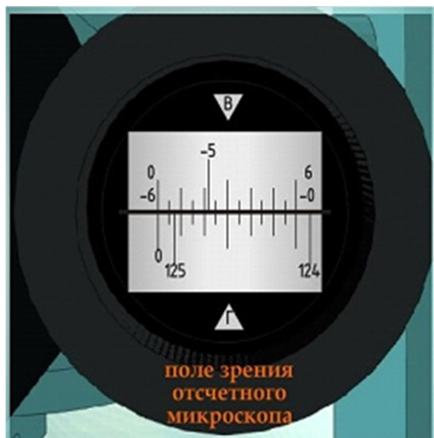
Рис. 2. Отсчетное устройство теодолита 2Т30П. Отсчет по шкале вертикального круга: -5^{\circ}38'30'' , по шкале горизонтального круга: 125^{\circ}07'
