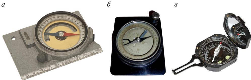
Рис. 2. Горные компасы различных конструкций:
