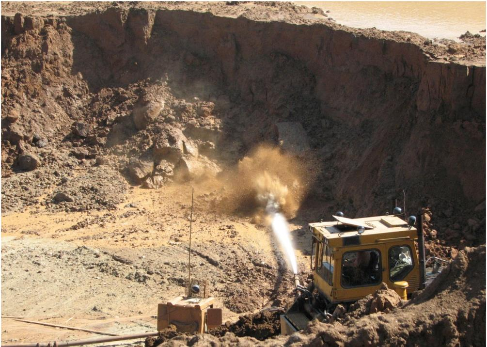
Рис. 27. Размыв золотоносных песков гидромонитором (фото А. С. Венгерова)
