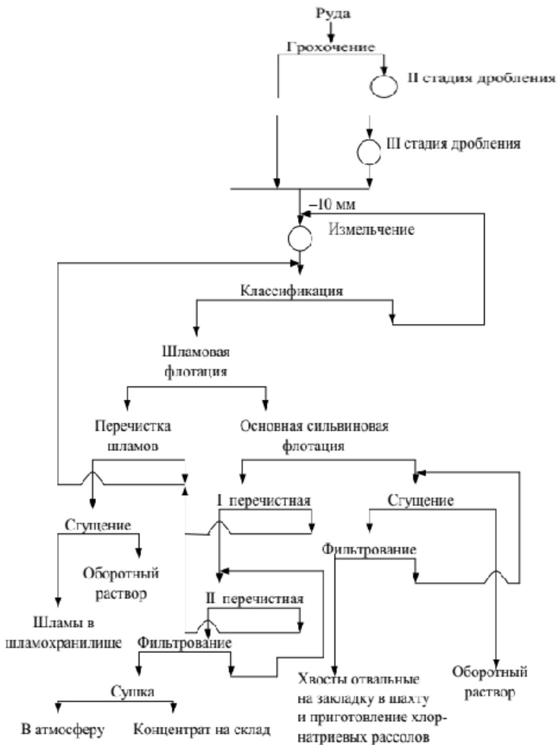
Рис. 7.8. Технологическая схема обогащения сальвинитовой руды Березниковского месторождения
