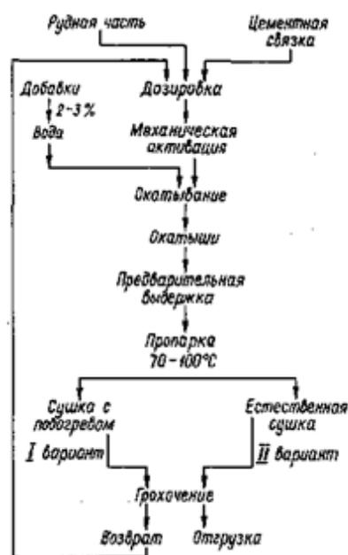
Рис. 8.1. Технологическая схема производства окатышей методом ускоренного твердения
