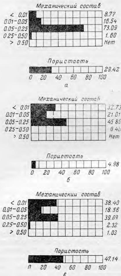
Рис. 64. Гистограммы механического состава и пористости песков (а, б, в). И. М. Губкин, 1937.
