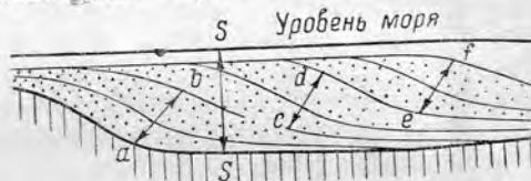
Рис. 6. Схема соотношения между глубиной бассейна и мощностью осадков.
