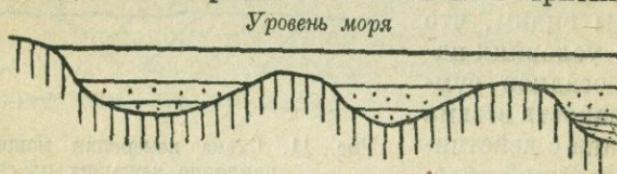
Рис. 8. Гипотетическая невозможная схема накопления осадков при ингрессии моря.
