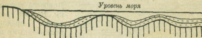
Рис. 9. Действительная схема расположения осадков при ингрессии моря.
