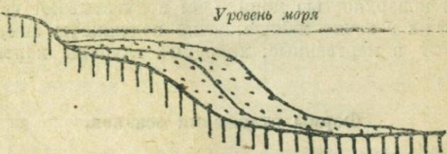
Рис. 6. Схема накопления осадков у берега—наиболее распространенная.
