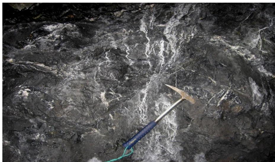
Рисунок 17 - Рудное тело золотоносных окварцованных алевролитов, вскрытое в горной выработке месторождения Бакырчик [40]
