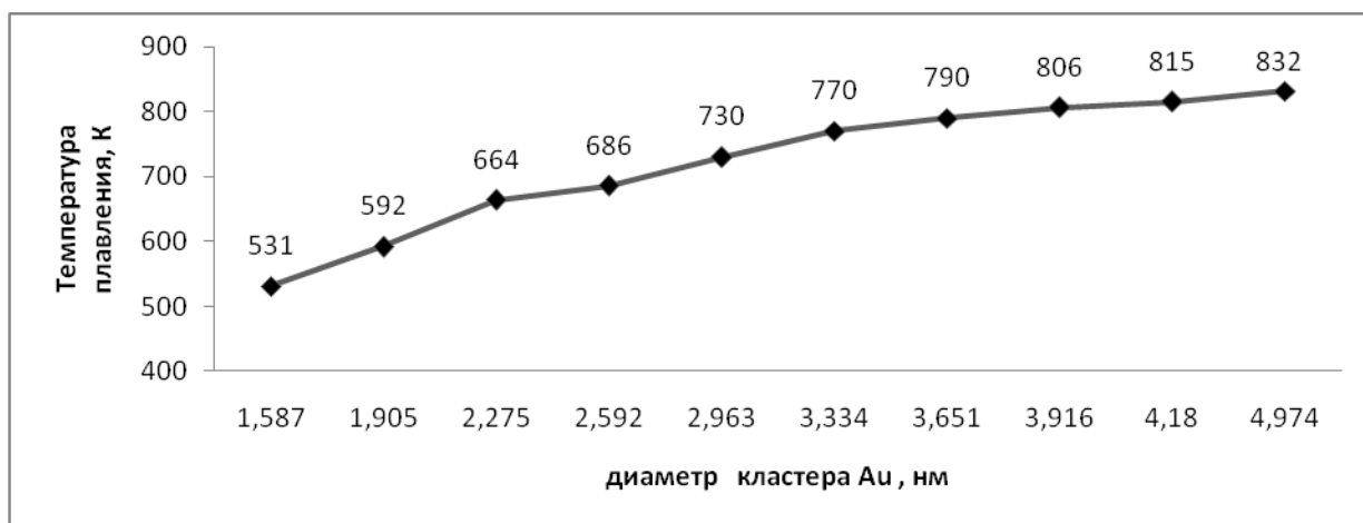
Рисунок 85 - Зависимость температуры плавления Au от размера кластера (с использованием данных Головенько Ж.В., 2012)
