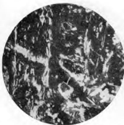
Рис. 37. Амфиболово-хлоритовая порода (измененный пироксенит) с реликтовой структурой. Ник.+,  $\times 25$ .
