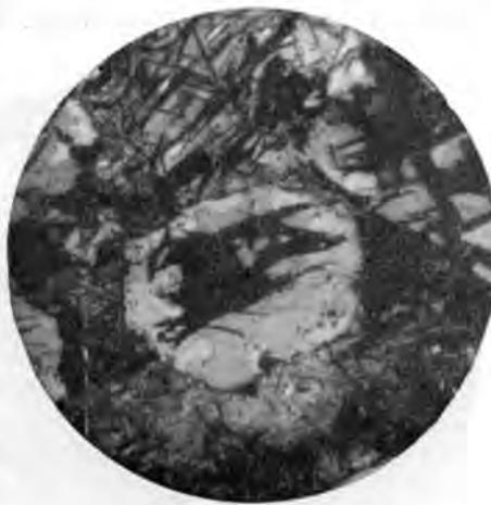
Рис. 85. Выделение пентландита (белое) в периферических частях сульфидно-силикатных псевдоморфоз по оливину. Серое — пирротин и халькопирит. Темно-серое — магнетит, черное — хлорит. Отраженный свет,  $\times 86$ .
