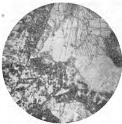
Рис. 20. Соссюритизированное оливинодержащее габбро. Пироксен сохранился и имеет хорошую огранку. При одном ник.,  $\times 30$ .
