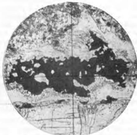
Рис. 117. Почти полное замещение гнезда карбоната сульфидами (черное). При одном ник.,  $\times 95$ .
