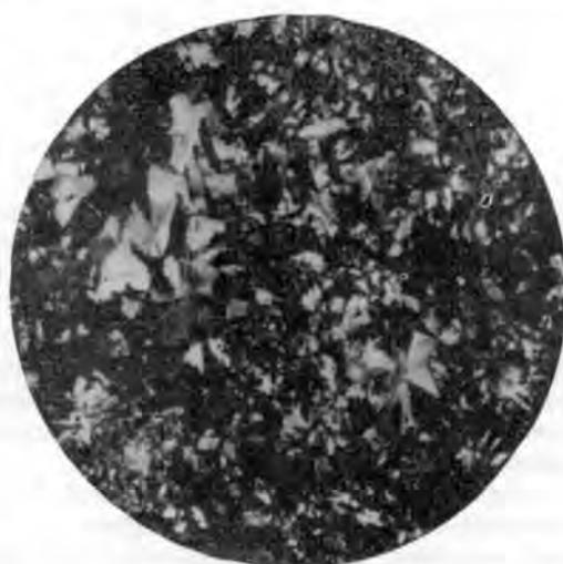
Рис. 51. Пироксено-гранатовая порода из диабазовой дайки. Ник +.  $\times 30$ .
