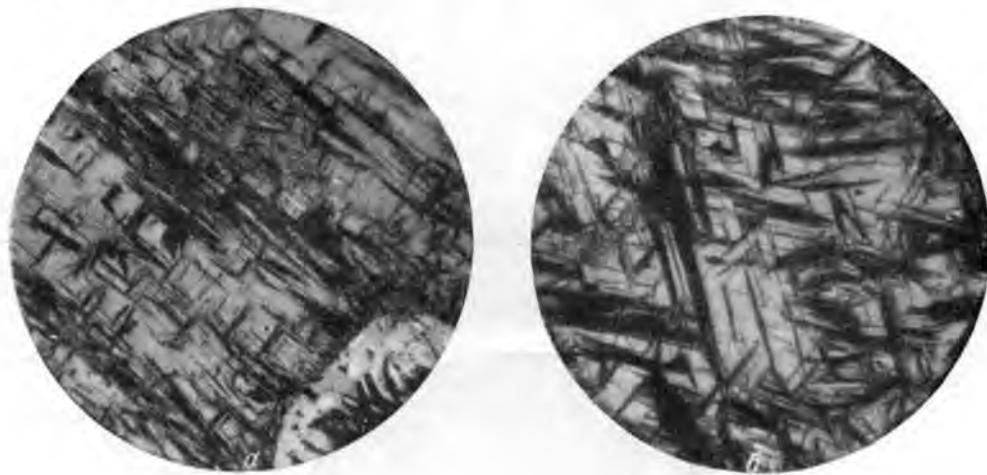
Рис. 83. Ориентированное расположение пластинок хлорита (черное) вдоль направлений спайности моноклинного пироксена (а) и амфиболя (б) в сильно оруденелом серпентините. Светло-серое — пирротин, белое — пентландит. На обоих снимках хорошо видно, что тонкие пластинки пентландита среди пирротиновой массы ориентированы параллельно главному направлению иголочек хлорита. Отраженный свет,  $\times 201$ .
