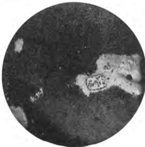
Рис. 109. Вкрашенник сульфидов не замещенный вторичным магнетитом; *по* — пирротин, *пн* — пентландит. Отраженный свет,  $\times 36$ .
