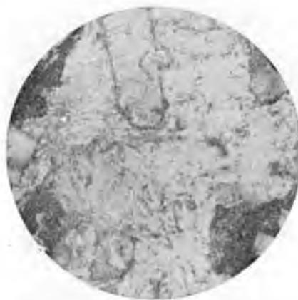
Рис. 27. Габбро-порфирит с вкрапленниками призматического моноклинного пироксена, основная масса имеет флюидальную текстуру и состоит из плагиоклаза и пироксена.
