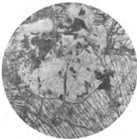
Рис. 110. Замещение tremolитом (иголочки) и сульфидами (черное) серпентина, слагающего псевдоморфозу по оливину. Минерал со спайностью — пироксен. При одном ник.,  $\times 60$ .
