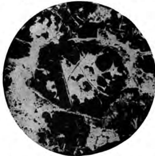
Рис. 53. Обломок интенсивно измененного серпентинита. Сульфиды метасоматически замещают серпентинит. В центральной части рисунка псевдоморфозы серпентина по оливину замещаются сульфидами и тальком. Темное — сульфиды, светлое — тальк. При одном ник.,  $\times 55$ .
