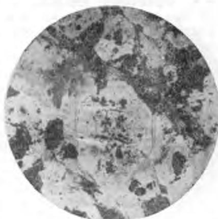
Рис. 15. Серпентинит с реликтовой структурой перидотита. Оливин замещается агрегатами чешуек антигорита. В центре поля зрения находится псевдоморфоза по оливину, выполненная одним кристаллом серпентина, — редкое явление при серпентинизации. Пироксен нецело замещен хлоритом и окислами железа. Чёрное — сульфиды и магнетит. Ник.+,  $\times 48$
