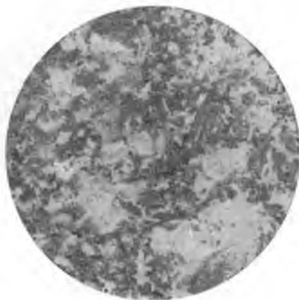
Рис. 29. Эндоконтактовый серпентинизированный перидотит. Оливин пацело замещен серпентином и хлоритом. Моноклинный пироксен призматической формы в значительной степени сохранился. При одном ник.,  $\times 25$ .
