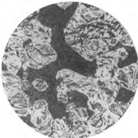
Рис. 100. Сидеронитовая вкрапленность сульфидов (черное) в серпентинизированном оливините. При одном ник.,  $\times 32$ .
