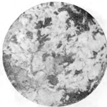
Рис. 35. Тальково-карбонатная порода с зернами сульфидов (черное). Ник.+,  $\times 25$ .
