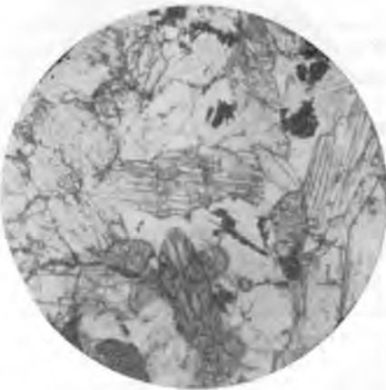
Рис. 18. Оливиновый пироксенит. Зерна оливина хлоритизированы и частично замещены сульфидами. При одном ник.,  $\times 30$ .
