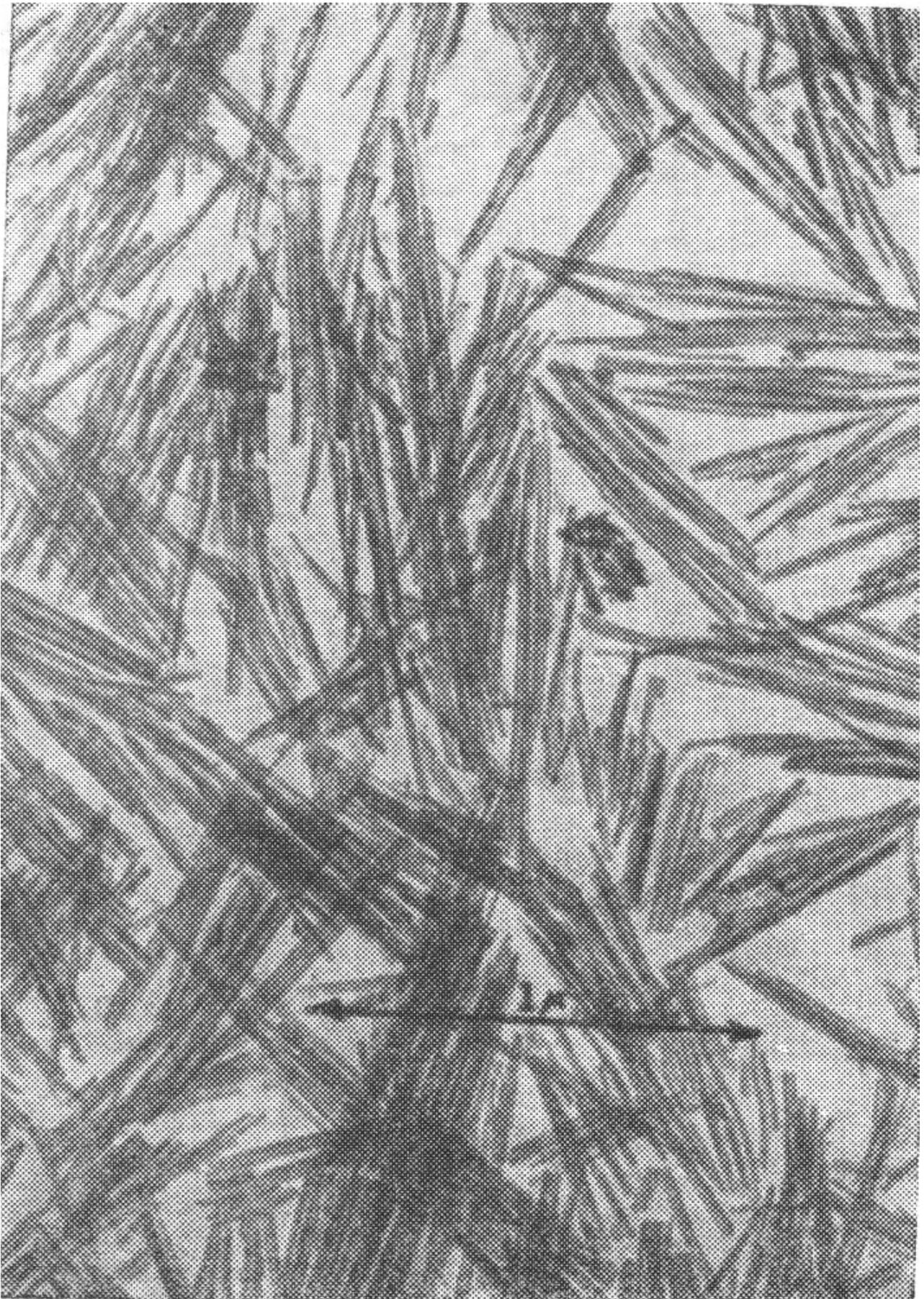
Рис. 1.17. Электронная микрофотография аттапульгита
