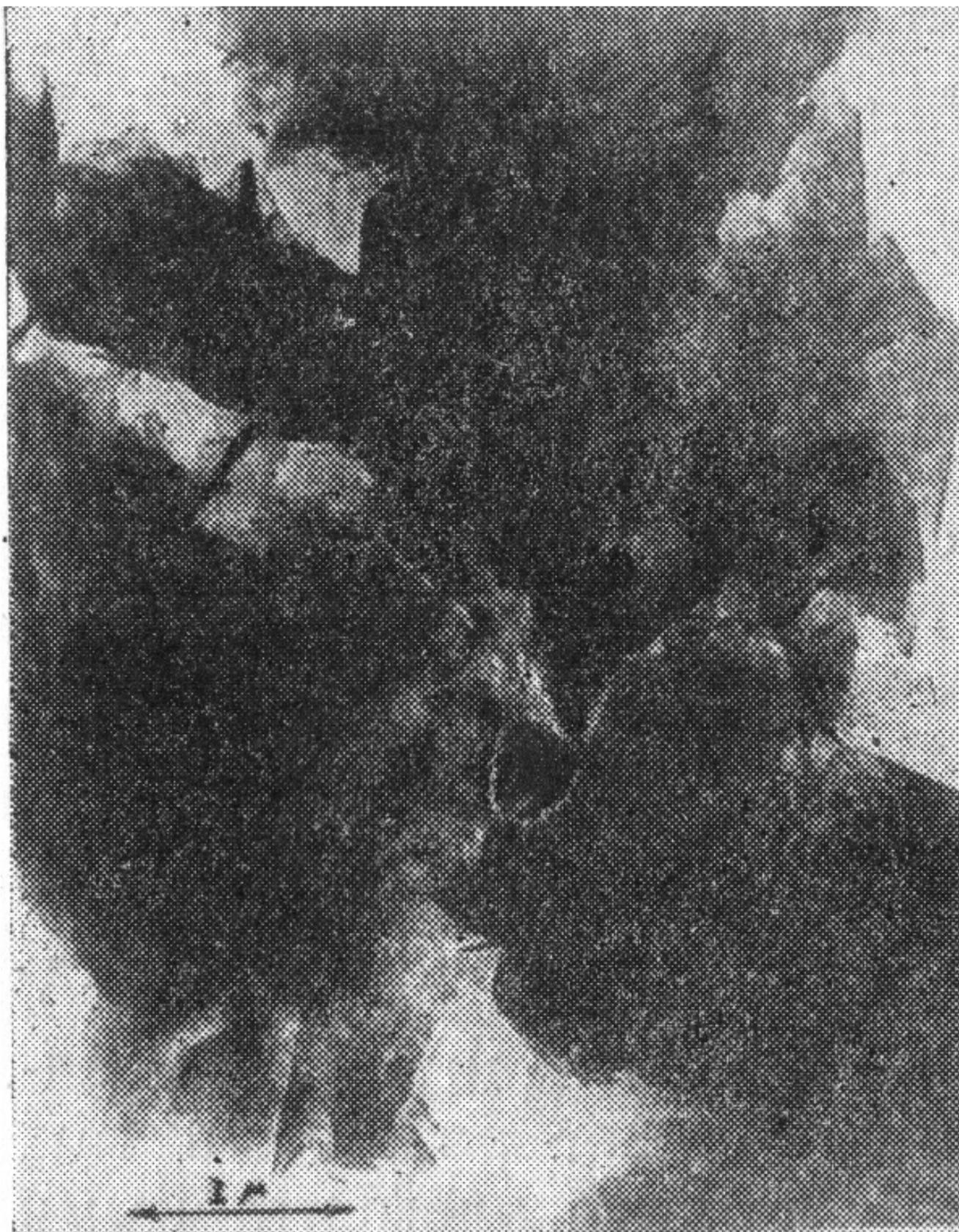
Рис. 1.8. Электронная микрофотография монтмориллонита (бентонита);
