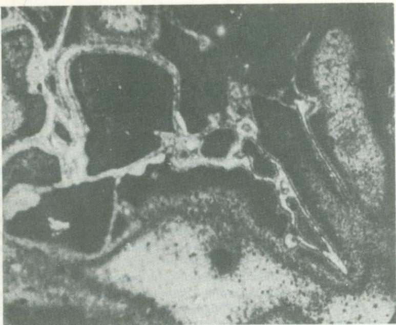
Рис. 1. Коррозионные структуры, образованные срастанием зонального низкопробного золота и более позднего высокопробного (светлое) золото. Полированый шлиф, протравлено. Увел. 540
