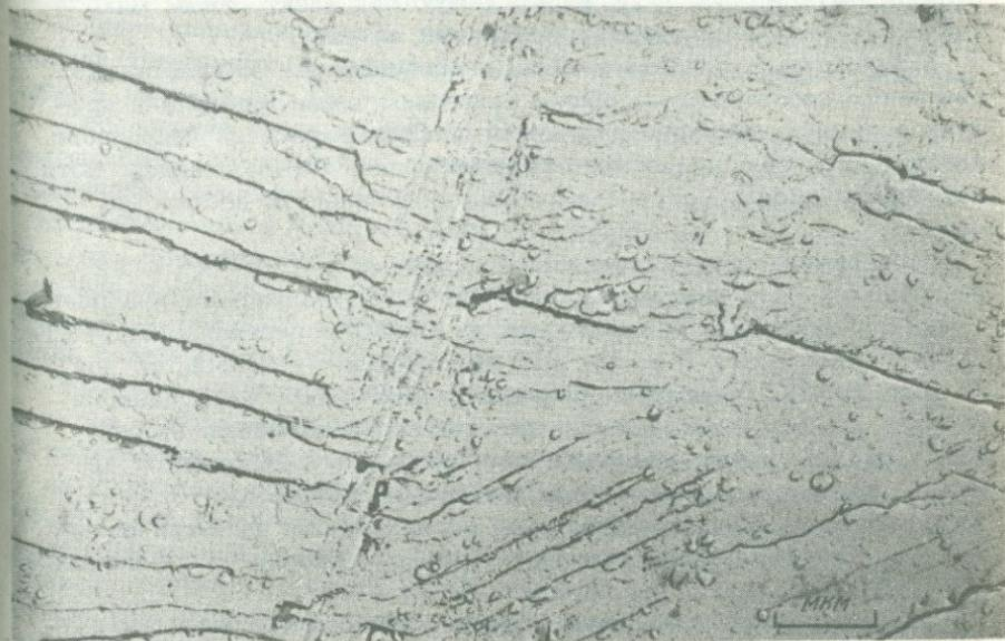
Рис. 3. Зародышевые выделения алтита различной морфологии и размера в галените. Целлюлозо-угольная реплика
