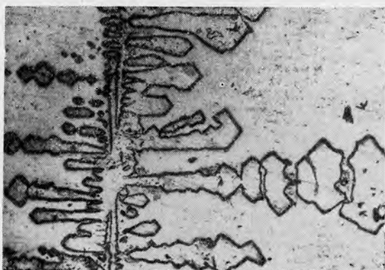
Рис. 12. Дендрит самородного серебра I в рамельсбергите (микрофото рельефнополированного после травления аншлифа; \times 70 ).
