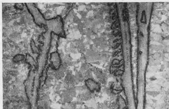
Рис. 15. Тонкая корка настурана II (черное) вокруг кристаллов самородного висмута I в зернистом агрегате раммельсбергита (микрофото шлифа; николи скрещены; \times 70 ).
