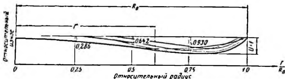
Рис. 45. Износ торцевой поверхности барабана в относительных единицах
