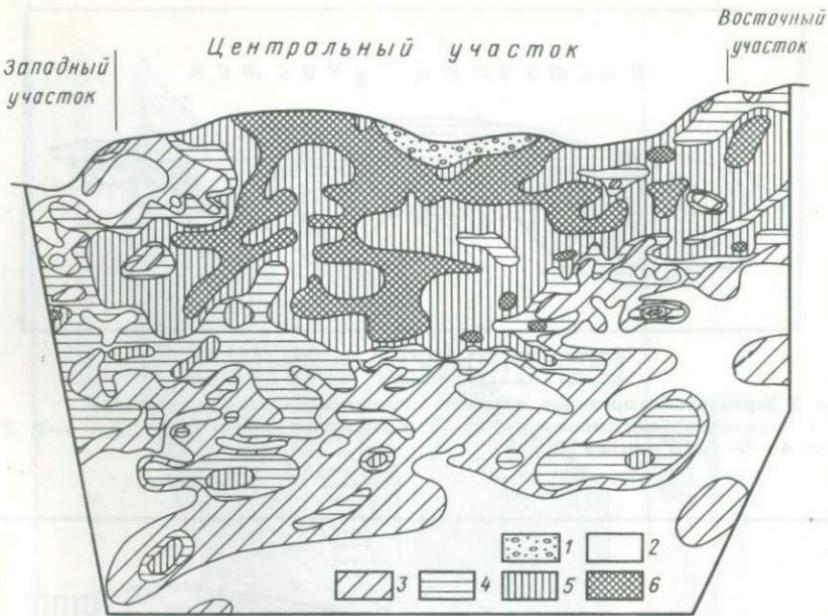
Фиг. 1. Вертикальная проекция изолиний содержаний флюорита в рудном теле
