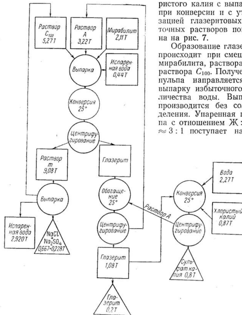
Рис. 7. Принципиальная технологическая схема получения сульфата калия с выпаркой
