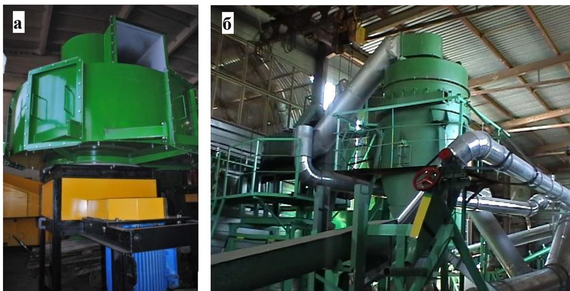
Рисунок 1.10 – Воздушные классификаторы КЦД (а) и КЦС (б)
