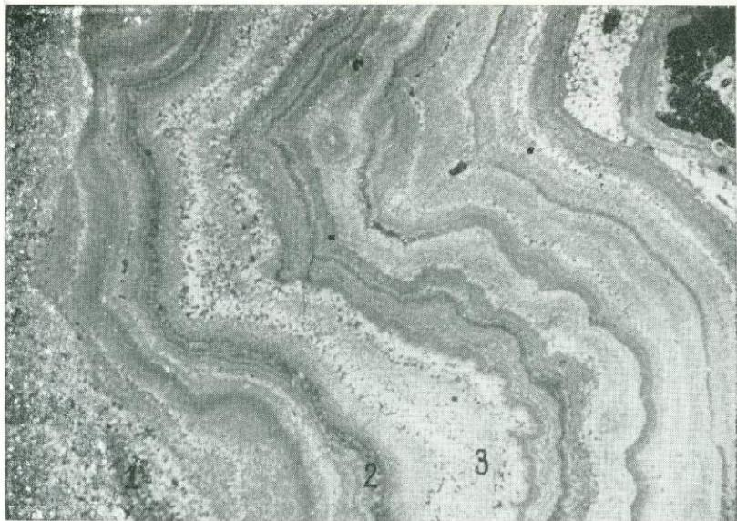
Фото 6. Тонкое чередование кварцевых полос различной морфологии и зернистости с полосами кварц-адулярового (1), кварц-хлоритового (2) и кварц-аргентитового (3) состава. Шлиф,  $\times 25$ , николи X.
