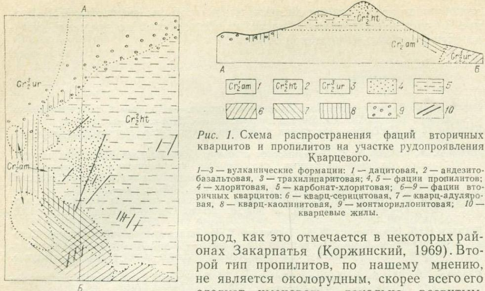
Рис. 1. Схема распространения фаций вторичных кварцитов и пропилитов на участке рудопроявления Кварцевого.
