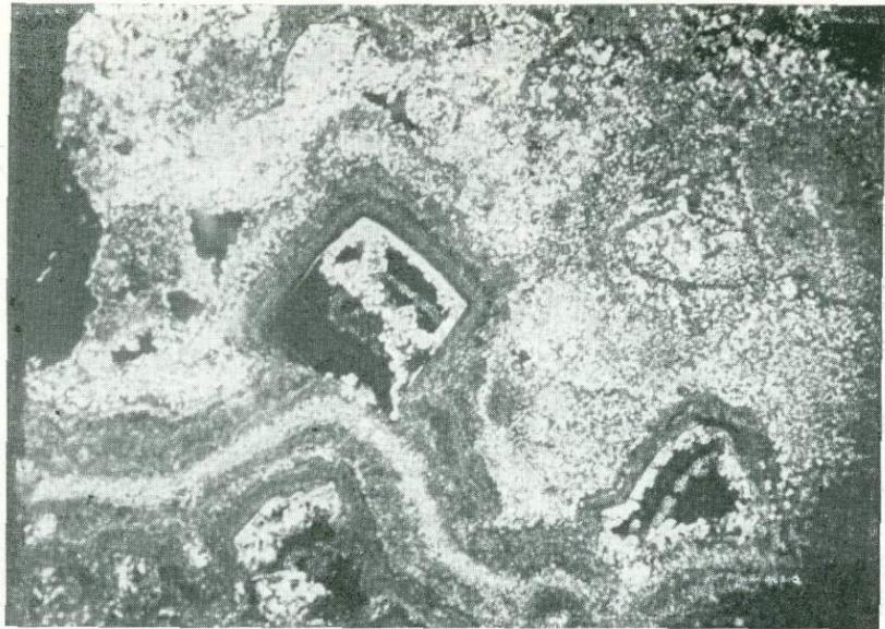
Фото 4. Отложение мелкозернистого кварца на месте выщелоченного карбоната. Шлиф,  $\times 50$ , николи X.
