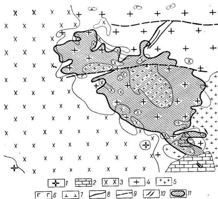
Рис. 3. Схематическая геологическая карта меднорудного штока Кальмакыр (по З. А. Васильевой)
