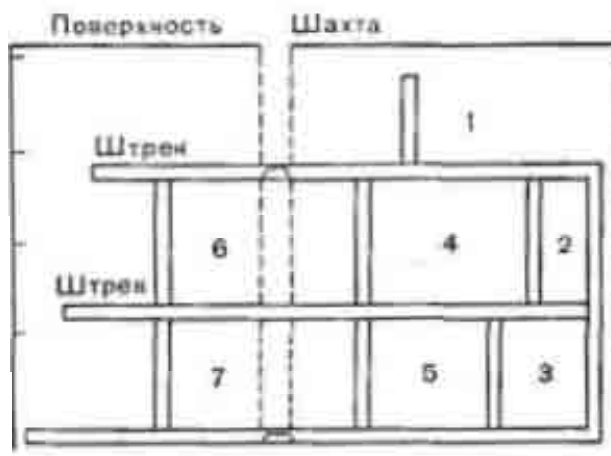
Рис. 2. Вскрытие месторождения шахтой с квершлагами
