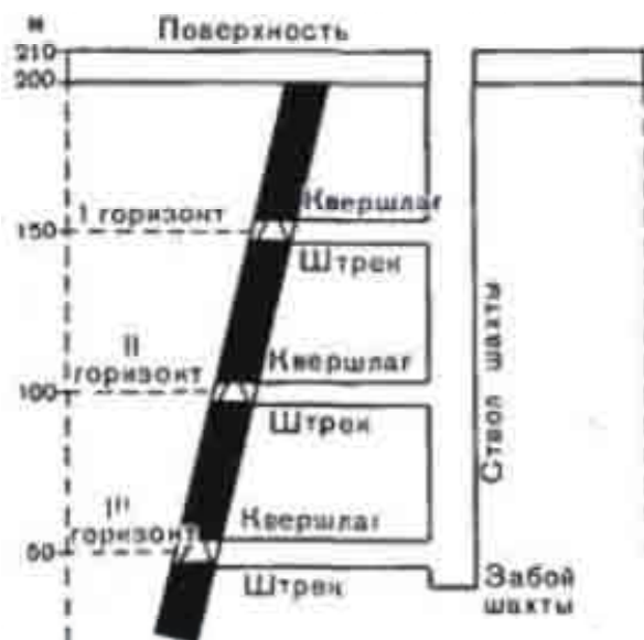
Рис. 2. Вскрытие месторождения шахтой с квершлагами
