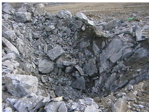
Рис. 5.12. Очищенные экскаватором от породы воронки взрыва: а – с комбинированной металлической и засыпной забойкой; б - с засыпной забойкой
