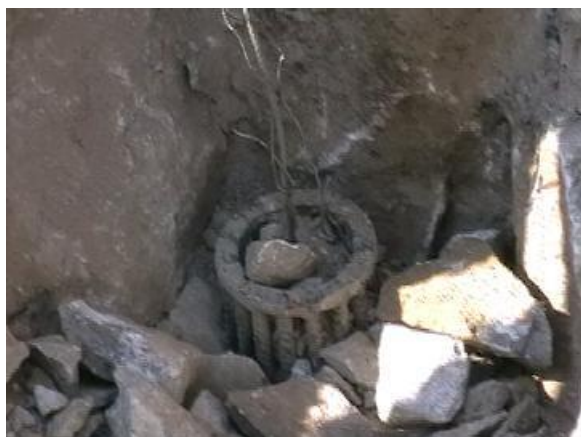
Рис. 4.32. Результаты взрыва скважины с цилиндрической подвесной забойкой: a – забойка после раскопки; б – воронка выброса со скважиной в камуфлетную полость
