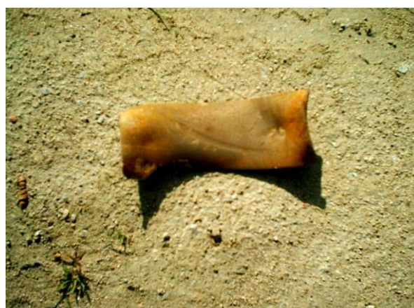
Рис. 4.27. Фрагменты металлических забоек после взрыва
