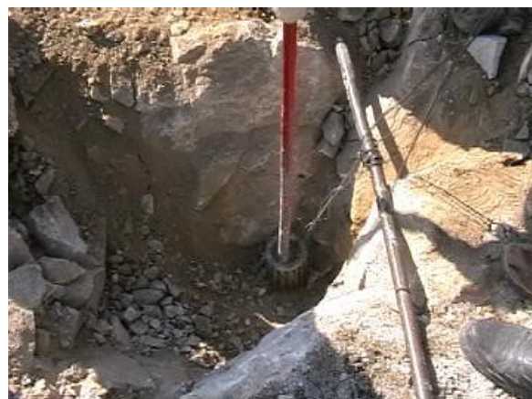
Рис. 4.32. Результаты взрыва скважины с цилиндрической подвесной забойкой: a – забойка после раскопки; б – воронка выброса со скважиной в камуфлетную полость
