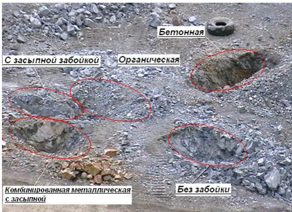
Рис. 5.11. Воронки выброса после очистки от горной массы экскаватором
