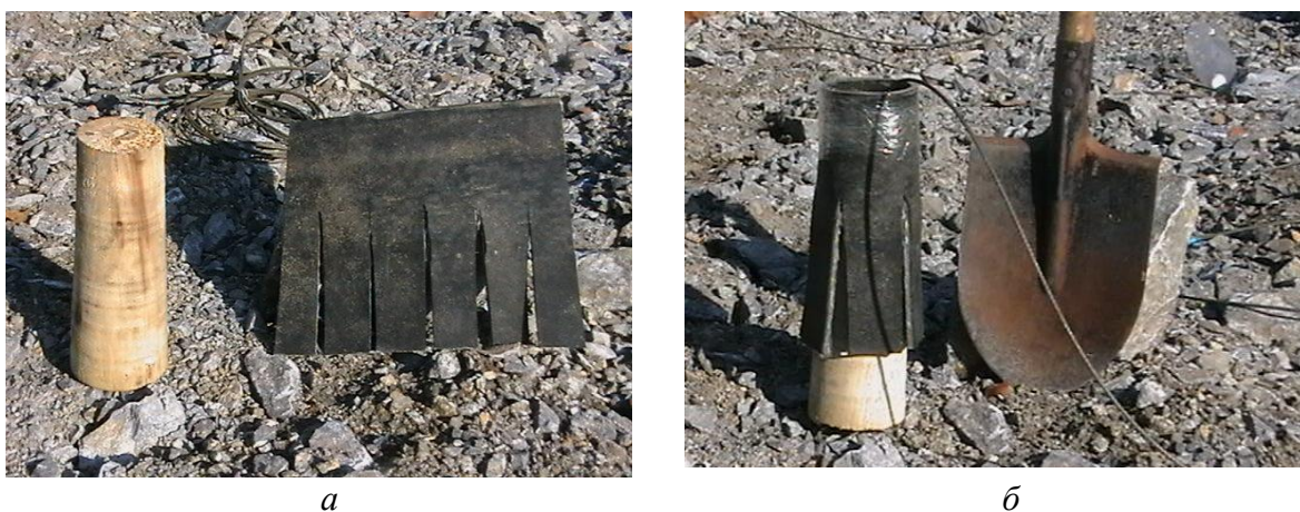
Рис. 5.6. Органическая забойка: а – элементы забойки; б – в сборе
