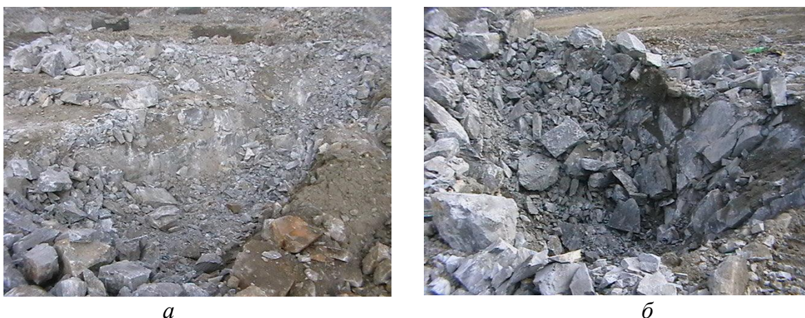
Рис. 5.13. Очищенные экскаватором от породы воронки взрыва: а – с комбинированной органической и засыпной забойкой; б – с засыпной забойкой
