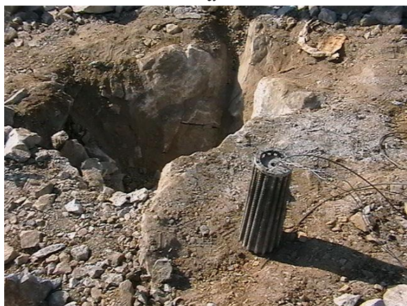
Рис. 4.33. Результаты взрыва скважины со стержневой подвесной забойкой: a, б – раскопка забойки; в – раскопанная воронка выброса; г – скважина в камуфлетную полость
