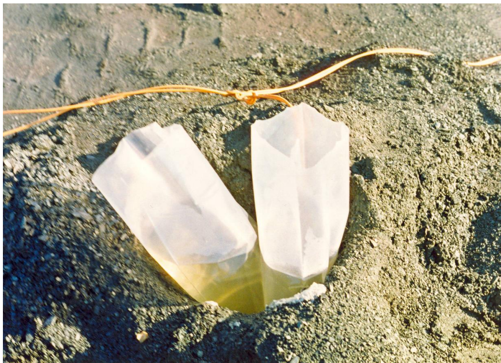
Рис. 2.13. Заливная забойка из водного раствора ПАВ над воздушным промежутком
