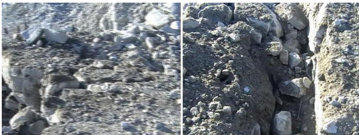
Рис. 3.8. Закол от скважины с забойкой из цементно-песчаной смеси вглубь массива ( а ) и вдоль уступа ( б )
