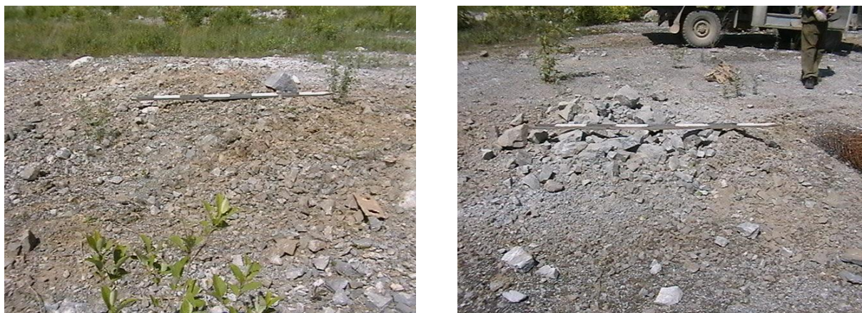
Рис. 3.13. Воронки выброса после взрыва скважин с засыпными забойками
