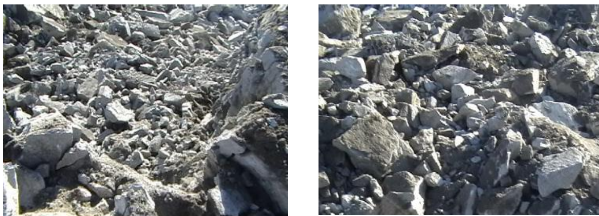
Рис. 3.8. Закол от скважины с забойкой из цементно-песчаной смеси вглубь массива ( а ) и вдоль уступа ( б )
