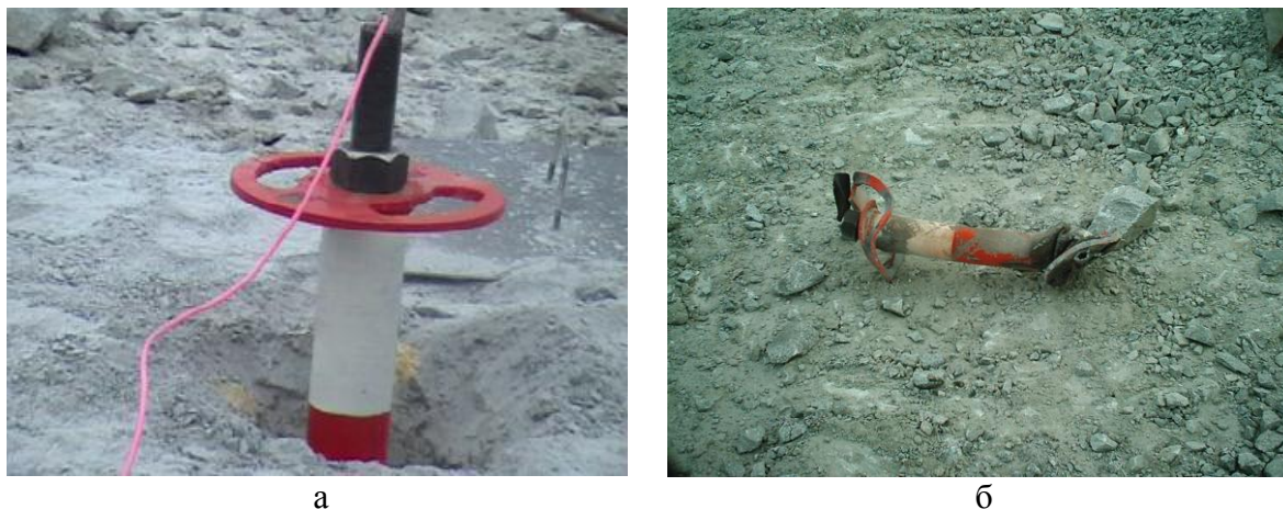
Рис. 4.18. Испытания забойки с направляющими штифтами: а – положение забойки после установки в скважину б – деформированное состояние забойки после взрыва
