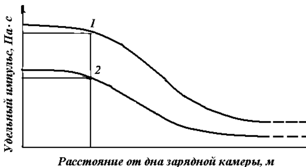
Рис. 1.6. Схема распределения удельных импульсов вдоль оси зарядной камеры удлиненной формы (по Ф. А. Бауму): 1 — с забойкой; 2 — без забойки
