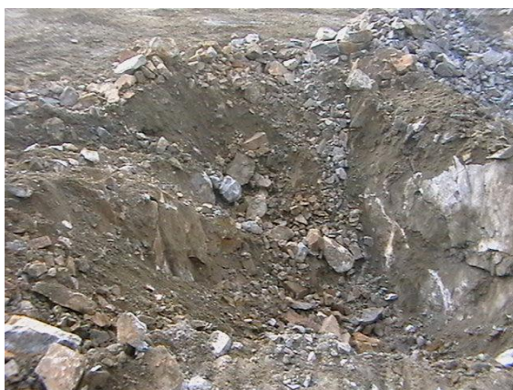
Рис. 5.12. Очищенные экскаватором от породы воронки взрыва: а – с комбинированной металлической и засыпной забойкой; б - с засыпной забойкой
