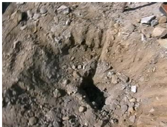
Рис. 4.32. Результаты взрыва скважины с цилиндрической подвесной забойкой: a – забойка после раскопки; б – воронка выброса со скважиной в камуфлетную полость
