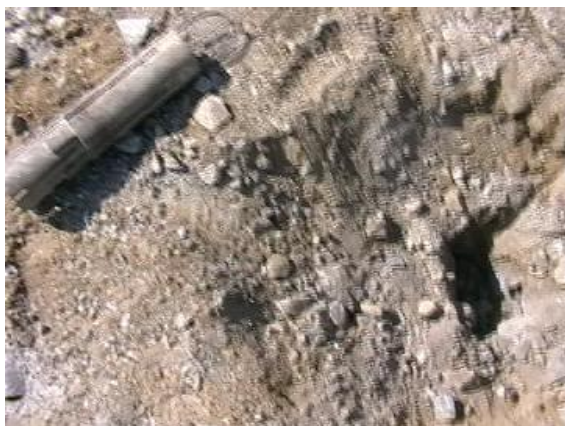
Рис. 4.32. Результаты взрыва скважины с цилиндрической подвесной забойкой: a – забойка после раскопки; б – воронка выброса со скважиной в камуфлетную полость
