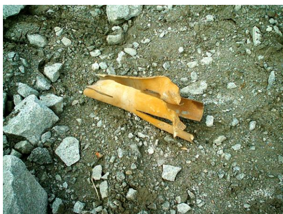
Рис. 4.27. Фрагменты металлических забоек после взрыва
