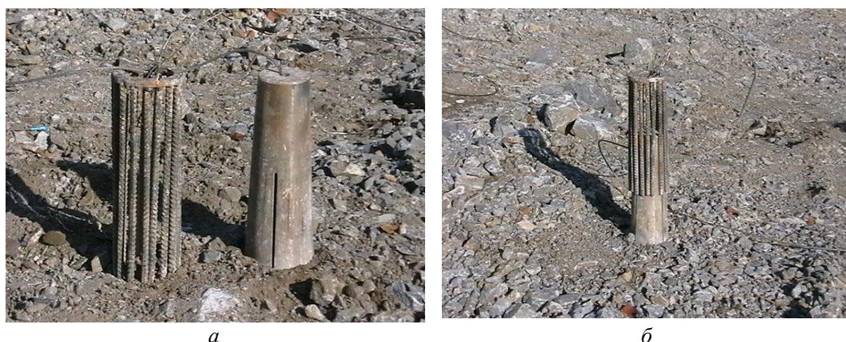
Рис. 5.9. Распорная металлическая забойка: а – сборочные единицы, б – в сборе
