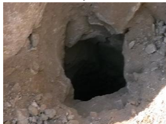
Рис. 4.33. Результаты взрыва скважины со стержневой подвесной забойкой: a, б – раскопка забойки; в – раскопанная воронка выброса; г – скважина в камуфлетную полость
