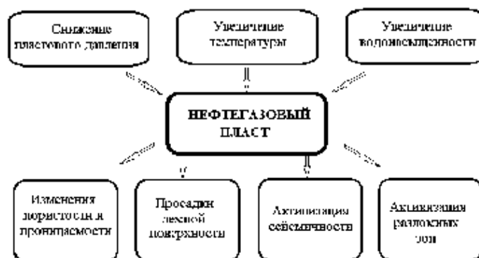
Рис.2. Основные факторы, влияющие на изменения физических свойств горных пород при разработке месторождений УВ.
