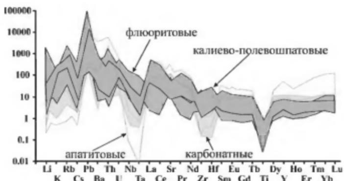
Рис. 4.27. Графики распределения элементов-примесей в бериллиевых рудах Ермаковского месторождения, нормированных к примитивной мантии, по [Sun, McDonough, 1989].
