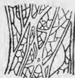
Рис. 23. Схема V-образной ящичной текстуры лимонита, образованного из галенита. По Блэнчарду и Босуэлду. \times 3 . Месторождение Руби Хилл, Невада.
