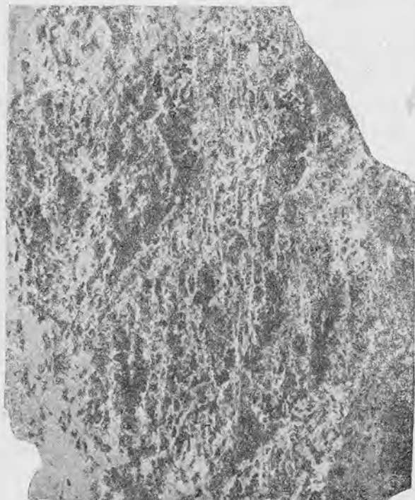
Рис. 21. Лимонит со «спайной» ящичной текстурой, образовавшийся из галенита. \times 1\frac{1}{2} . Месторождение Лаун Хилл, Квинсленд. Фото Блэнчарда-Босуэлла.
