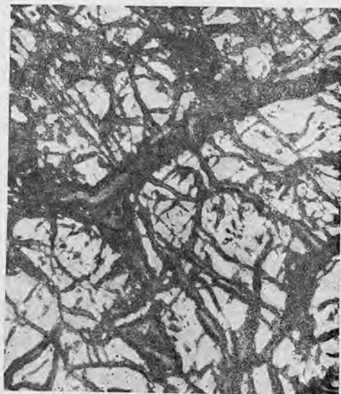
Рис. 27. Скородит (темносерый и черный), замещающий арсенопирит (белый). \times 25 . Гурулевское месторождение, Восточное Забайкалье. Фото Л. В. Радугиной.
