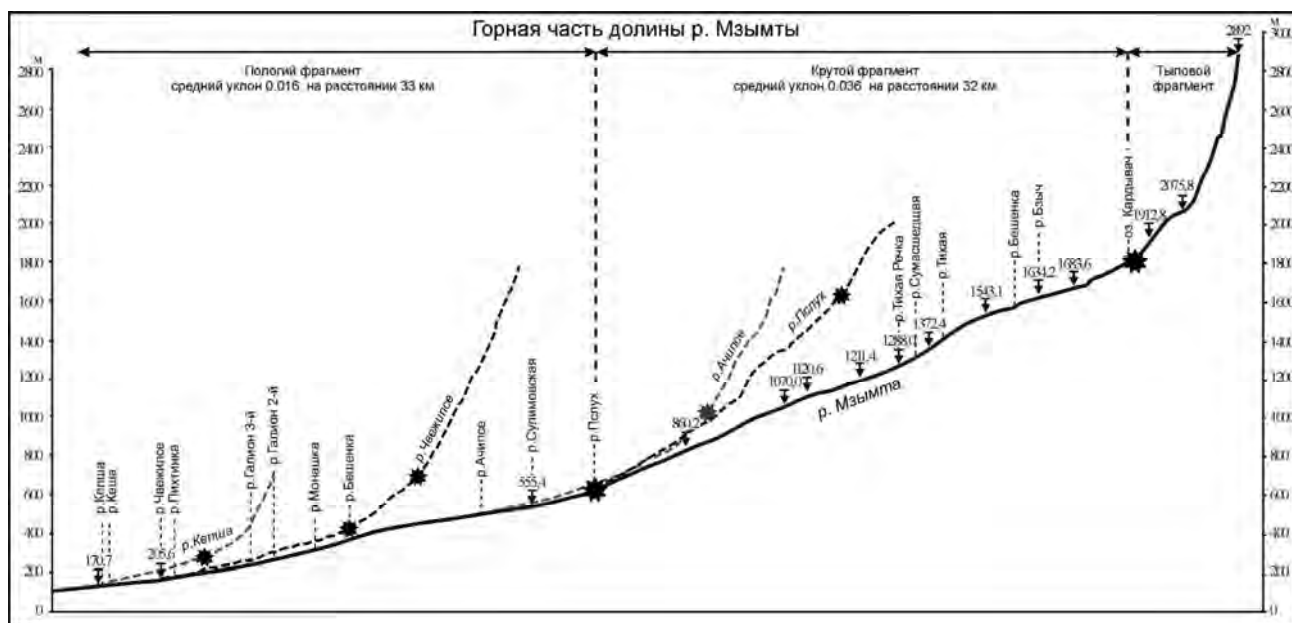
Рис. 8.21. Продольный профиль горной части р. Мзымты и ее основных правых притоков Звездочками отмечены места смены основных уклонов русел
