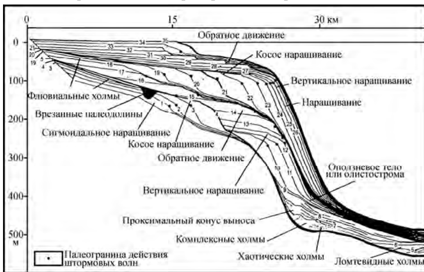
Рис. 3.6. Идеализированная схема строения секвенции на континентальной окраине и модели строения осадочных тел [Геоисторический..., 1999]
