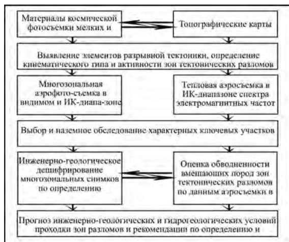
Рис. 5.8. Технологическая схема комплексного применения космофотосъемки, многозональной и тепловой аэросъемки для оценки обводненности зон разломов по трассам строящихся туннелей [Бгатов, Олохтонов, 1990].
