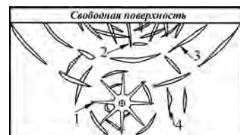
Рис. 9.11. Распределение главных трещин разрушения при взрыве заряда ВВ в среде [Моисинец, Абрамов, 1982].
